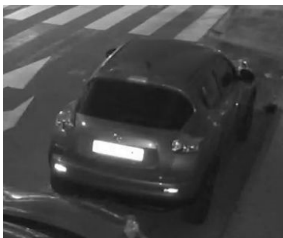
Fig. 16: Plaques d'immatriculation surexposées à cause d'une LED IR trop forte
