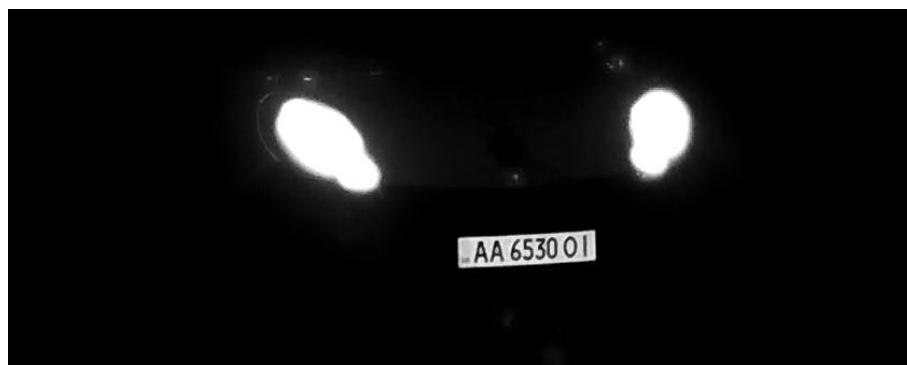
Fig. 10: Targa facilmente leggibile di notte con un'illuminazione LED a infrarossi
