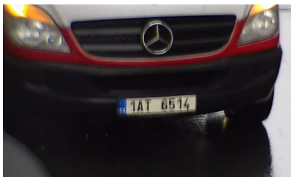
Fig. 14: Targa sfocata a causa di un tempo di esposizione lungo
