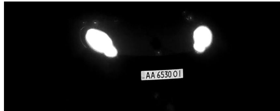
Plaque d'immatriculation facilement lisible de nuit avec un éclairage LED infrarouge
