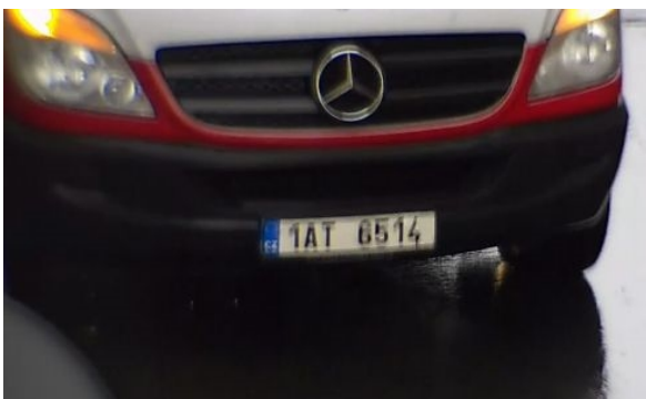
Fig. 14: Unscharfes Kennzeichen aufgrund langer Belichtungszeit
