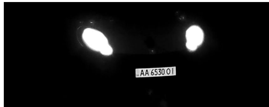
Fig. 10: Gut lesbares Kennzeichen bei Nacht mit Infrarot-LED-Beleuchtung
