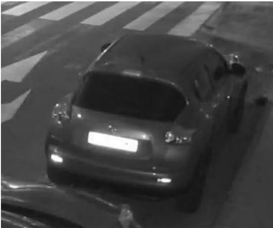
Fig. 16: Plaques d'immatriculation surexposées à cause d'une LED IR trop forte
