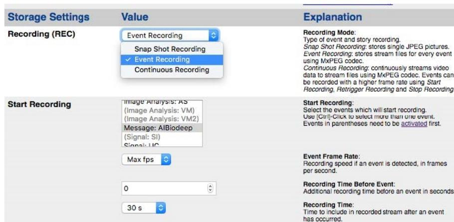
Fig. 17: Configurazione delle impostazioni di registrazione della telecamera
