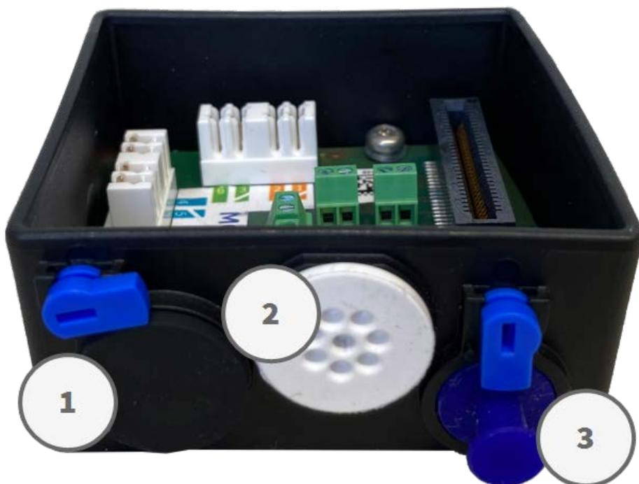
Fig. 48: Caja de conectores LSA
