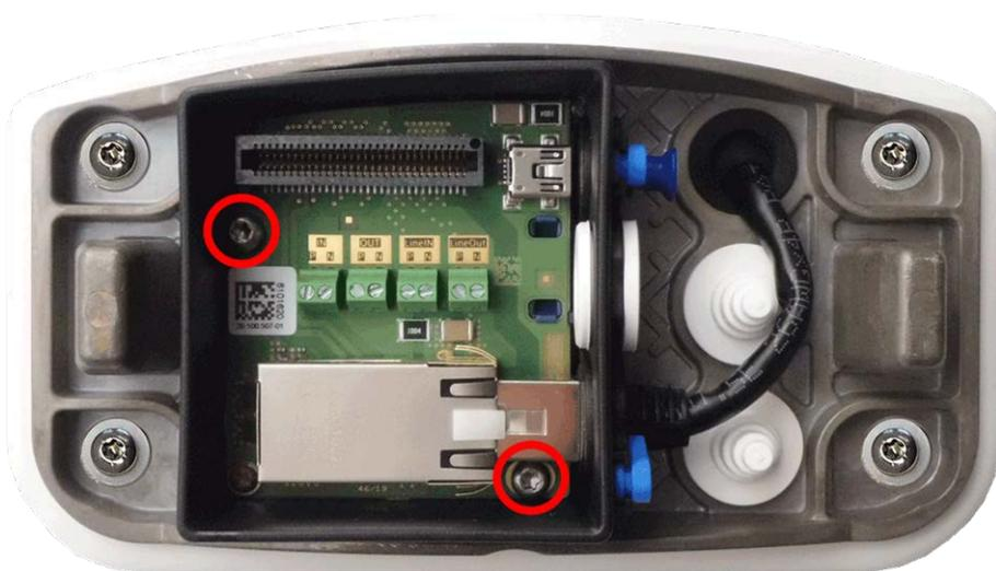
Fig. 55: Monte el Caja de conectores RJ45 (imagen superior) con los dos tornillos (resaltados en rojo) en la placa de montaje
