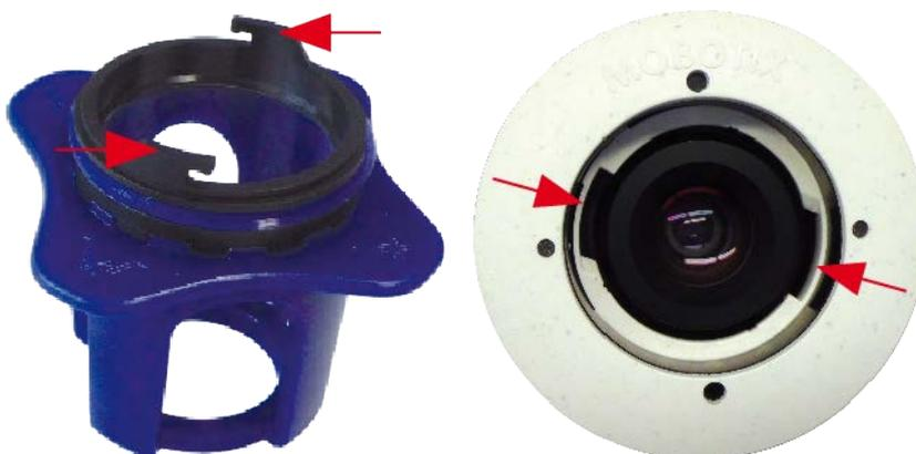
Fig. 85: Inserte el cristal de protección del objetivo con la llave de objetivo
