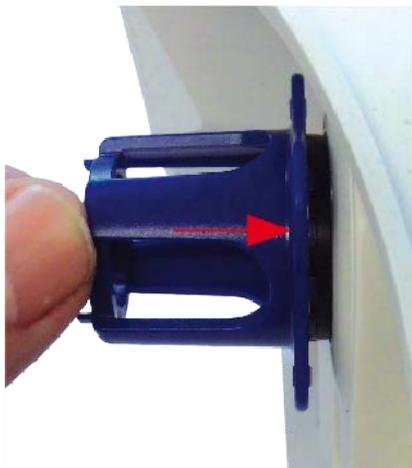
**Fig. 86:** Presione con fuerza para insertar el cristal de protección del objetivo y gírelo para encajar en su sitio
