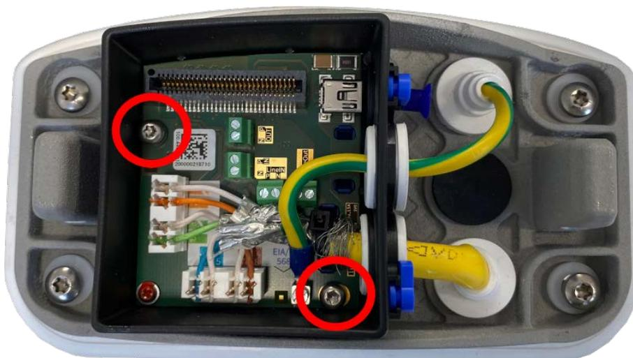
**Fig. 67:** Monte el Caja de conectores LSA (imagen superior) con los dos tornillos (resaltados en rojo) en la placa de montaje
