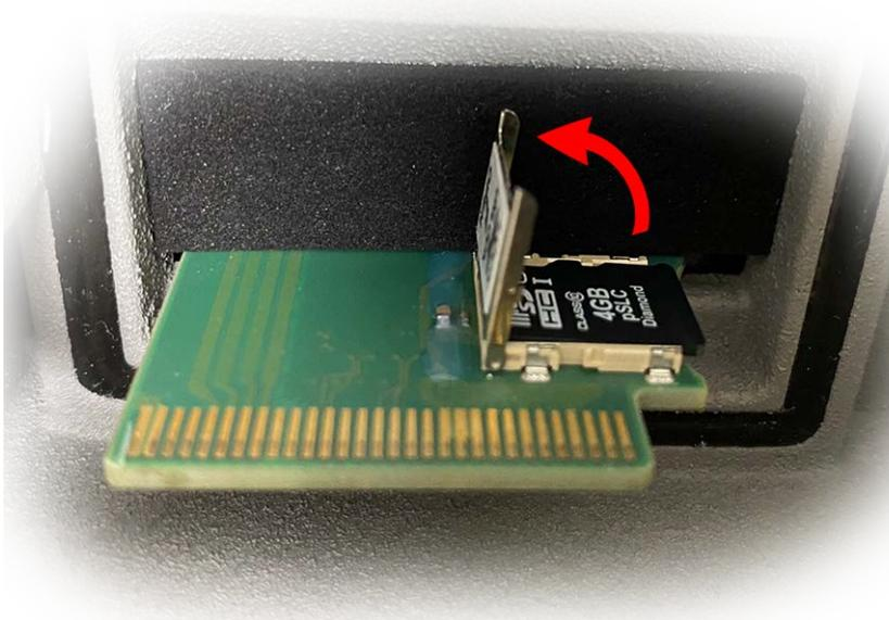
Fig. 94: Desbloquee el soporte de la tarjeta microSD
