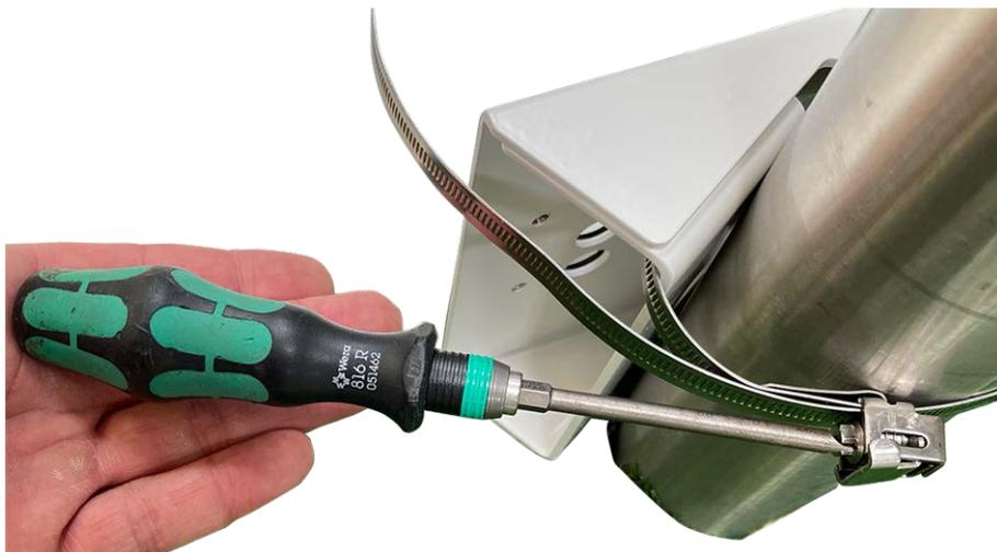
Fig. 42: Ajuste de las correas
