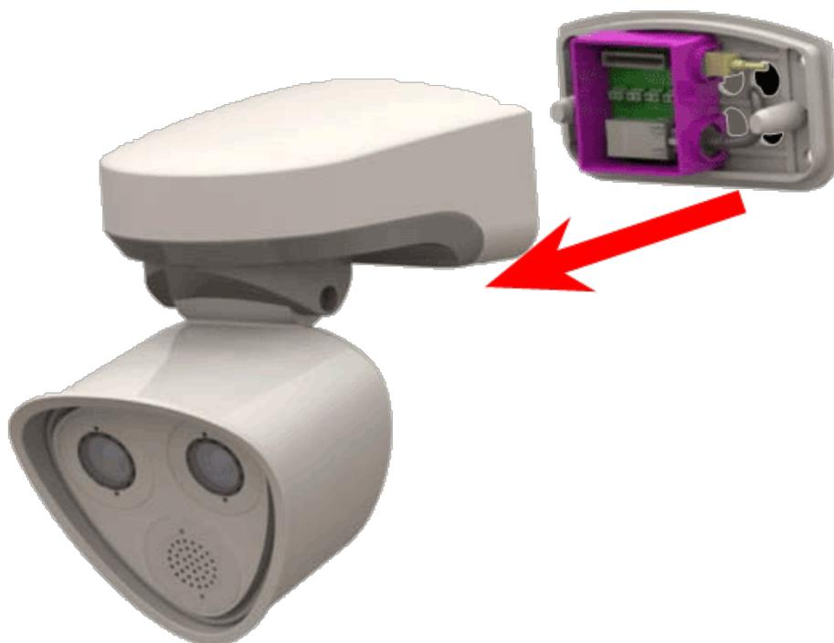
Fig. 92: Extraiga el chasis de la cámara de la placa de montaje
