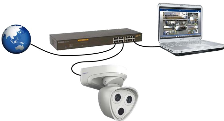
Fig. 52: Fuente de alimentación mediante un conmutador PoE según la PoE Plus (802.3at-2009)
