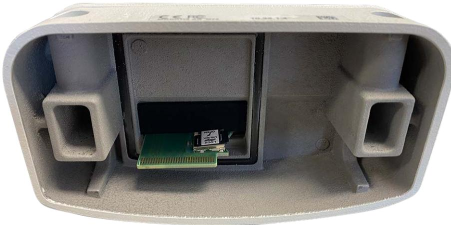
Fig. 93: Abra el chasis de la cámara
