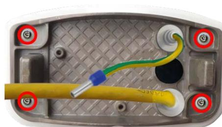
Fig. 51: Installata e pronto per Scatola dei connettori LSA
