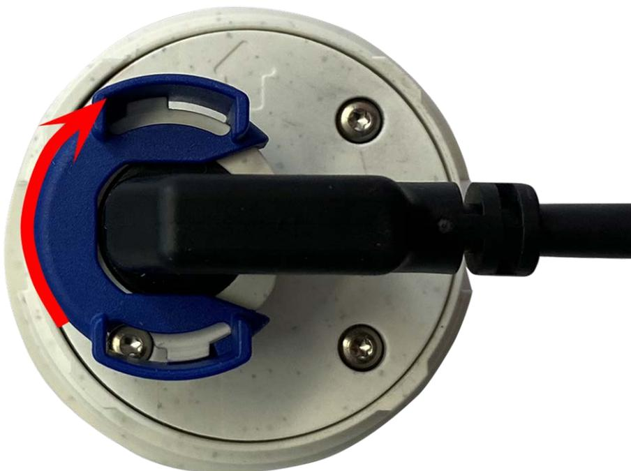
Fig. 28: Bloccare il cavo del modulo sensore
