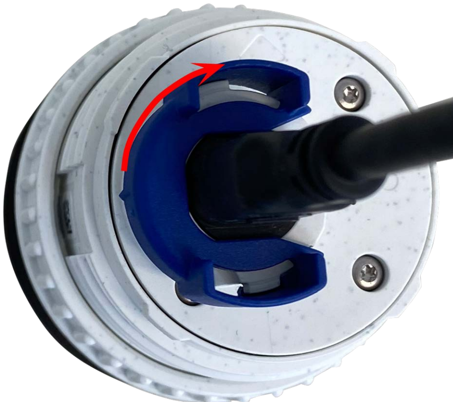
Fig. 12: Bloquee el cable del módulo del sensor
