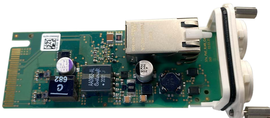
Fig. 17: Placa de interfaz RJ45
