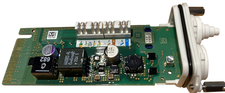
Fig. 20: Placa de interfaz LSA
