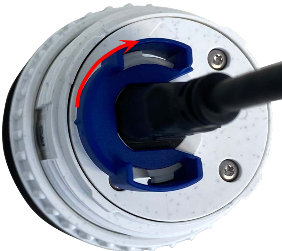
Fig. 12: Blocage du câble du module de capteur
