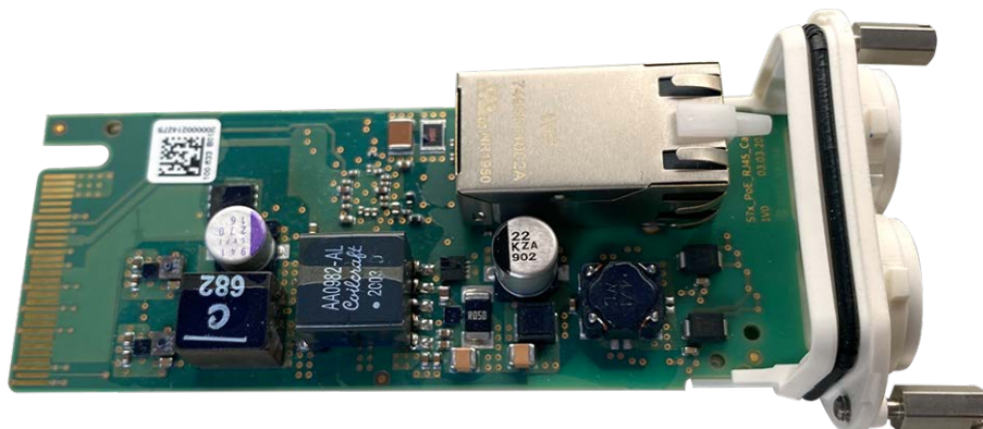
Fig. 17: Carte d'interface RJ45
