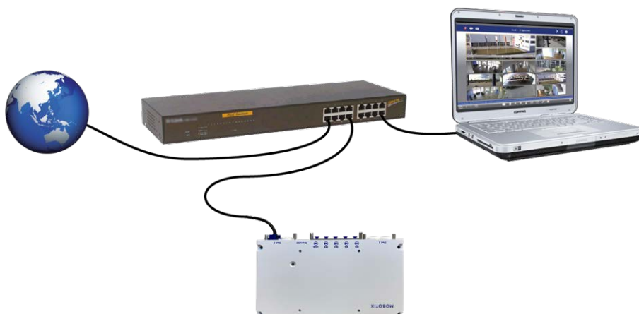
Fig. 34: Alimentazione tramite interruttore PoE in base allo standard PoE Plus (802.3at-2009)
