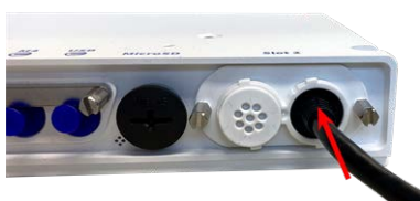
Fig. 35: Premere con decisione il tappo fino a quando l'anello di tenuta blu non scatta in posizione
