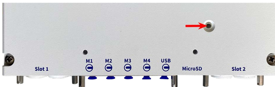
Fig. 36: LED della telecamera sulla parte superiore del corpo della telecamera
