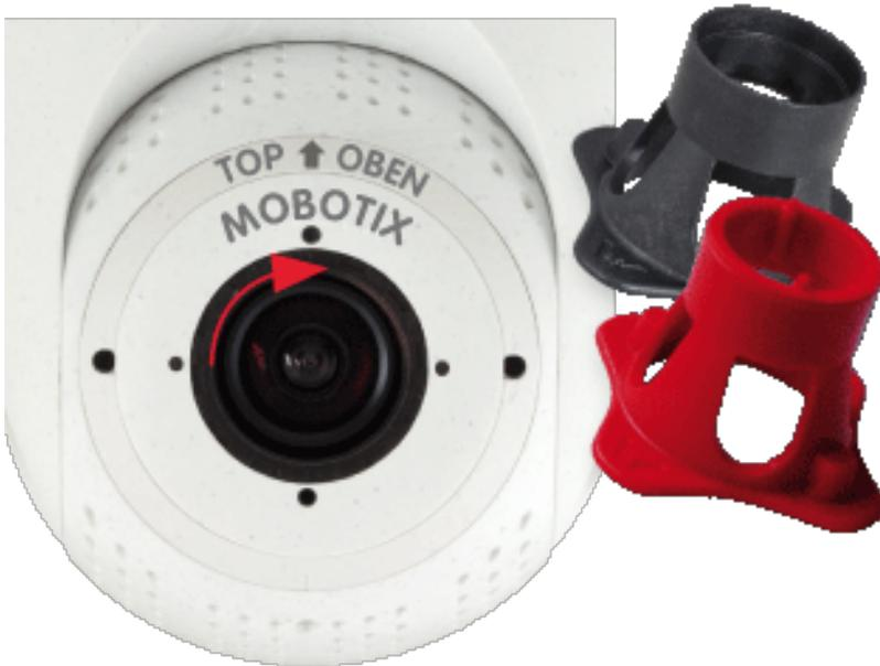
11. Befestigen Sie das Sensormodul, indem Sie den Gewindestift mit dem 2,5-mm-Inbusschlüssel festziehen. Der Gewindestift verriegelt das Sensormodul im Einsatz und verhindert ein versehentliches Entriegeln des Sensormoduls.
