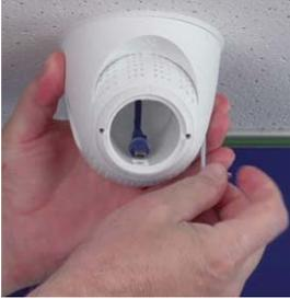
7. Lösen Sie die zwei Befestigungsschrauben des Einsatzes ① und drehen Sie den Einsatz so, dass der kleine Riegel gegenüber der Beschriftung **TOP/OBEN** auf das Loch des Gewindestifts ② zeigt. Sichern Sie den Einsatz gegen Verdrehen, indem Sie die beiden Befestigungsschrauben mit dem 2,5-mm-Inbusschlüssel festziehen.
