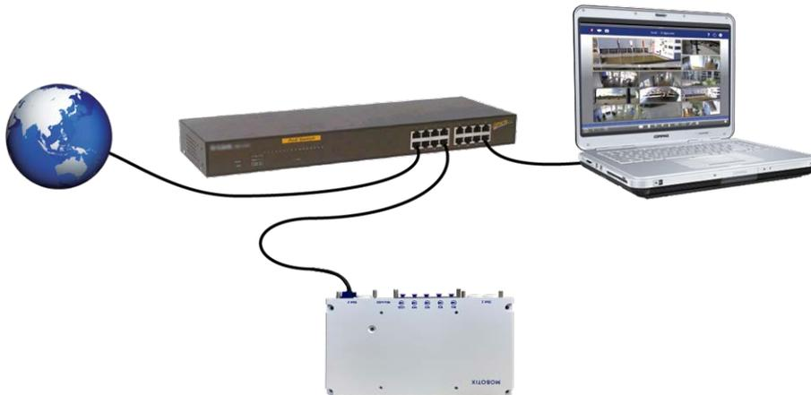
Fig. 34: Stromversorgung über PoE-Switch gemäß PoE Plus (802.3at-2009)
