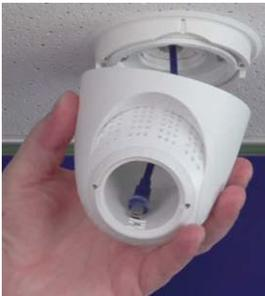
6. Befestigen Sie die Fuß- und Kugelbaugruppe mit den beiden Schrauben am Schwenkring und stellen Sie sicher, dass der Fuß noch gedreht werden kann.
