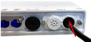
Fig. 35: Drücken Sie den Stecker fest ein, bis der blaue Dichtring einrastet.
