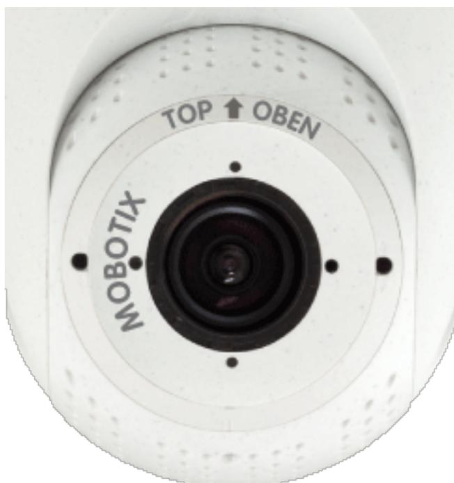
10. Verriegeln Sie mit dem Modulschlüssel (rot oder schwarz) das Sensormodul durch Drehen um 90 Grad nach rechts.
