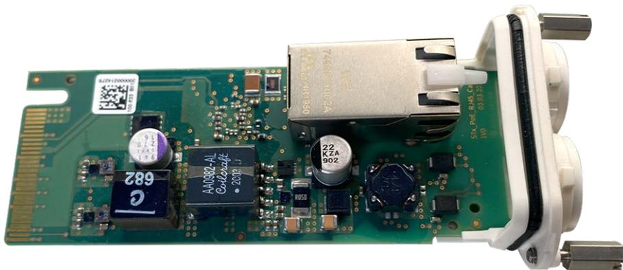
Fig. 17: RJ45-Schnittstellenkarte
