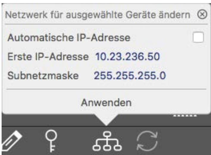
Fig. 42: Ändern der Netzwerkeinstellungen für ausgewählte Systeme
