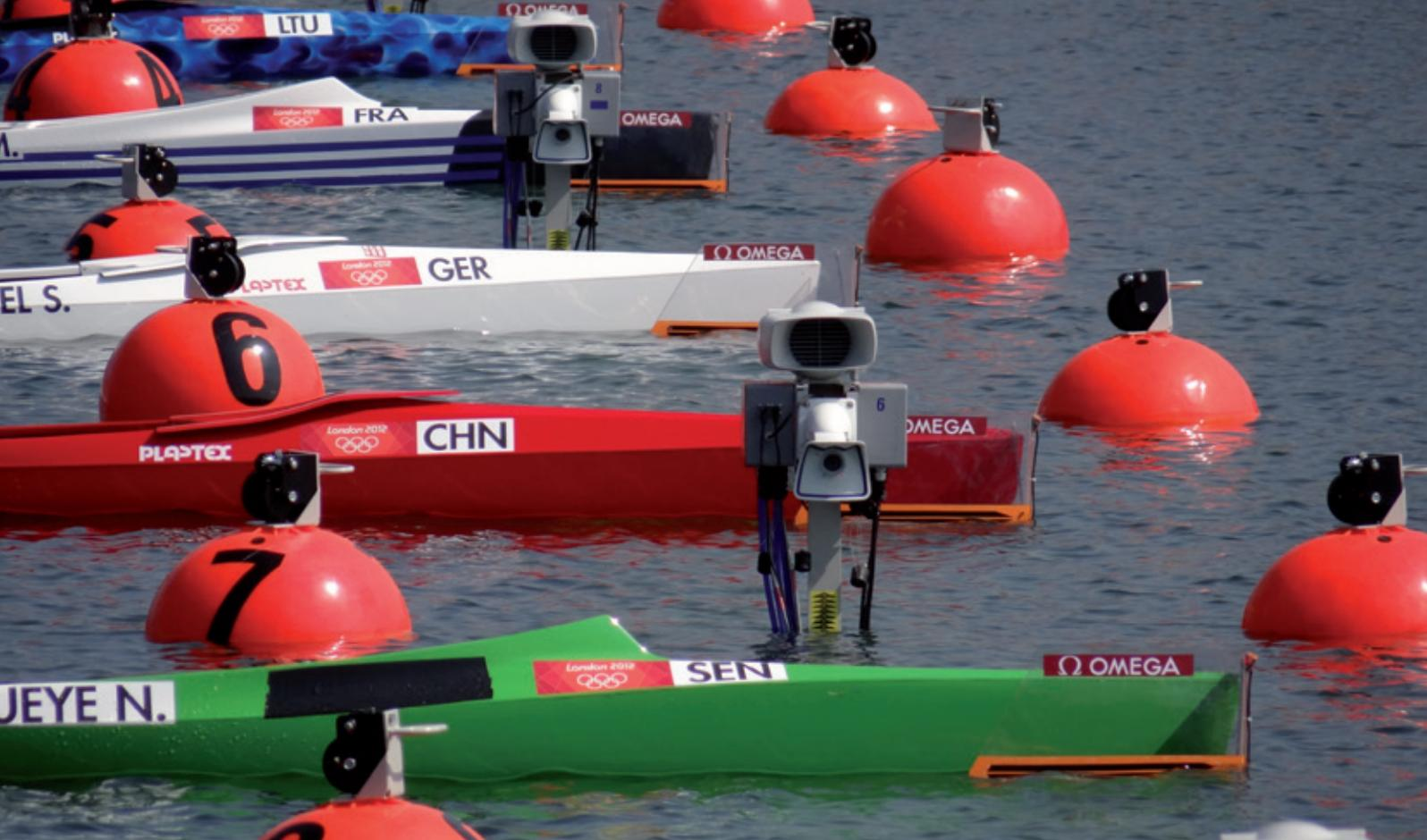
gegebenenfalls unterbrechen. Die aufgenommenen Videos werden auf einer Festplatte gespeichert, nach Durchlaufnummer sortiert und als gültiger Start oder Fehlstart gekennzeichnet. Das System kann auch im VCR-Modus verwendet werden. Hier wird aus dem Bereich der Startlinie wie mit einem konventionellen Videorekorder permanent aufgezeichnet.
