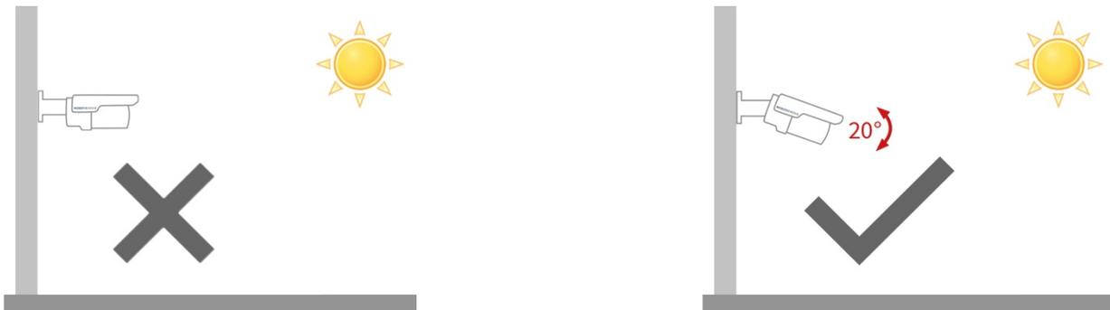
Richten Sie die Kamera nicht direkt auf die Sonne oder auf „stark“ reflektierende Objekte. Wenn möglich, richten Sie die Kamera in Richtung Norden, um eine direkte Sonneneinstrahlung aus Blickrichtung Süden zu vermeiden.
