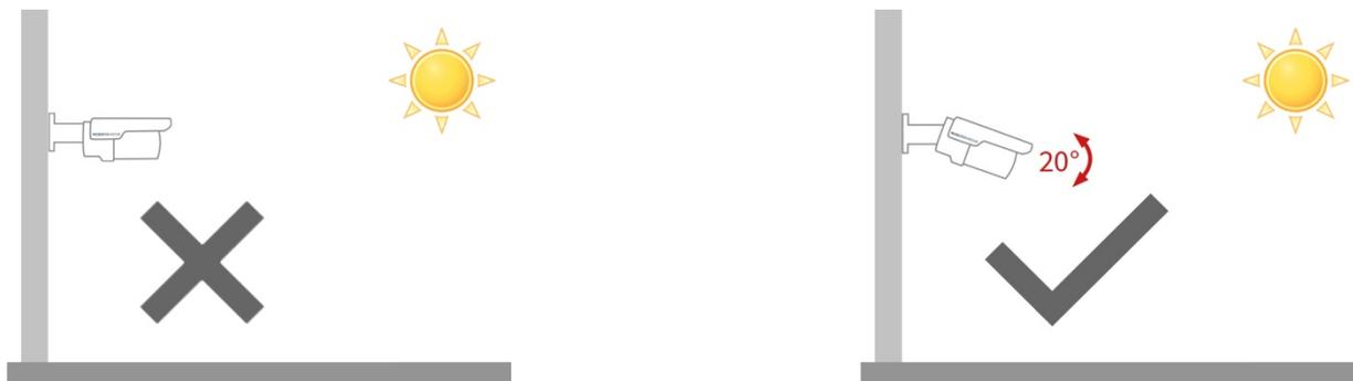
In ogni caso, evitare di indirizzare l'angolo di ripresa della videocamera verso la luce diretta del sole o verso oggetti altamente riflettenti. Se possibile, installare la videocamera verso nord per evitare l'esposizione verso la luce diretta del sole a sud.
