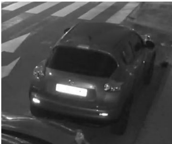
Fig. 17: Überbelichtete Kennzeichen aufgrund zu starken IR-LED-Lichts
