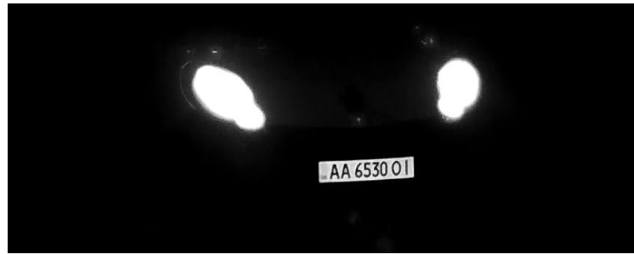
Fig. 11: Gut lesbares Kennzeichen bei Nacht mit Infrarot-LED-Beleuchtung
