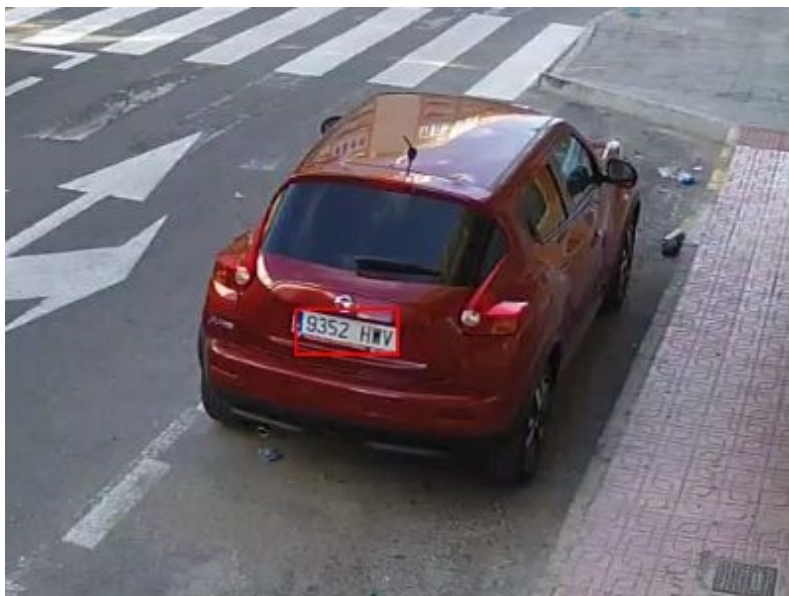
Fig. 19: Unzureichende Lichtverhältnisse zur Erkennung des Kennzeichens
