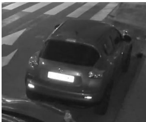
Fig. 17: Plaques d'immatriculation surexposées à cause d'une LED IR trop forte
