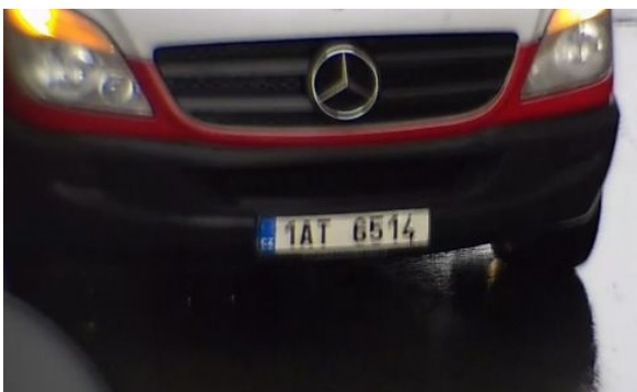
Fig. 13: Unscharfes Kennzeichen aufgrund langer Belichtungszeit
