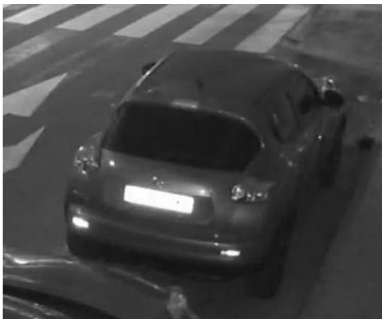
Fig. 15: Matrícula sobreexpuesta debido a luz LED IR demasiado intensa
