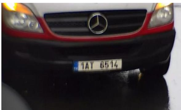
Fig. 13: Matrícula borrosa debido a un tiempo de exposición largo
