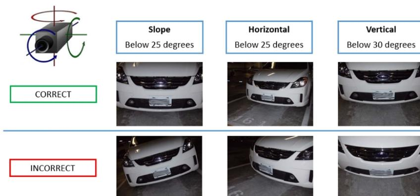
Fig. 11: Angle de rotation maximal
