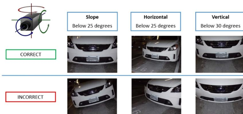
Fig. 11: Ángulo de rotación máximo
