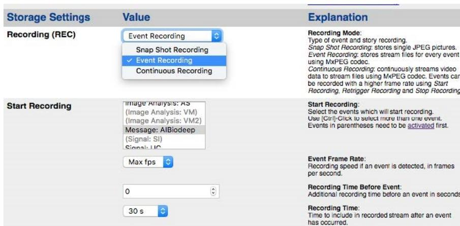
Fig. 18: Konfiguration der Aufnahmeeinstellungen der Kamera
