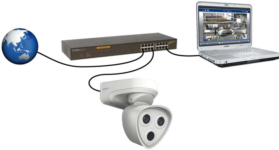
Fig. 52: Stromversorgung über PoE-Switch gemäß PoE Plus (802.3at-2009)
