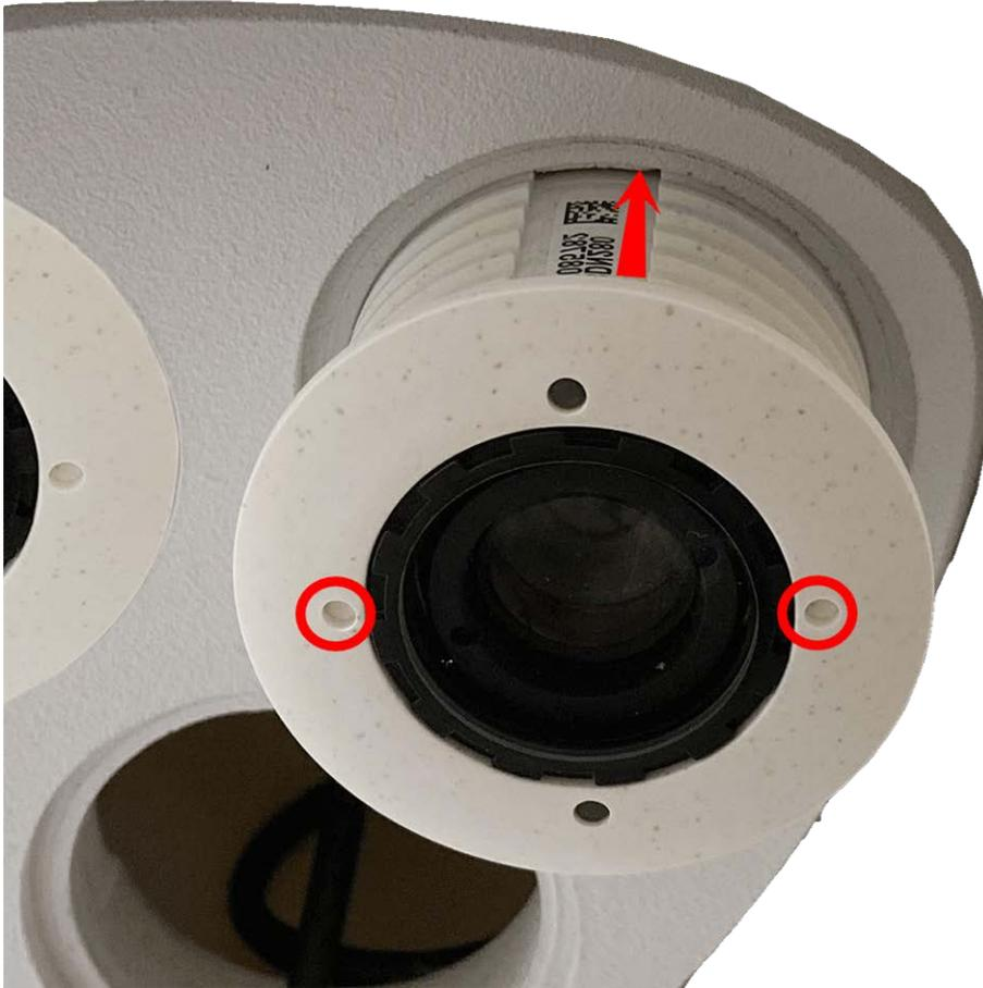
Fig. 25: Sensormodul in Thermal-Frontplatte einsetzen
