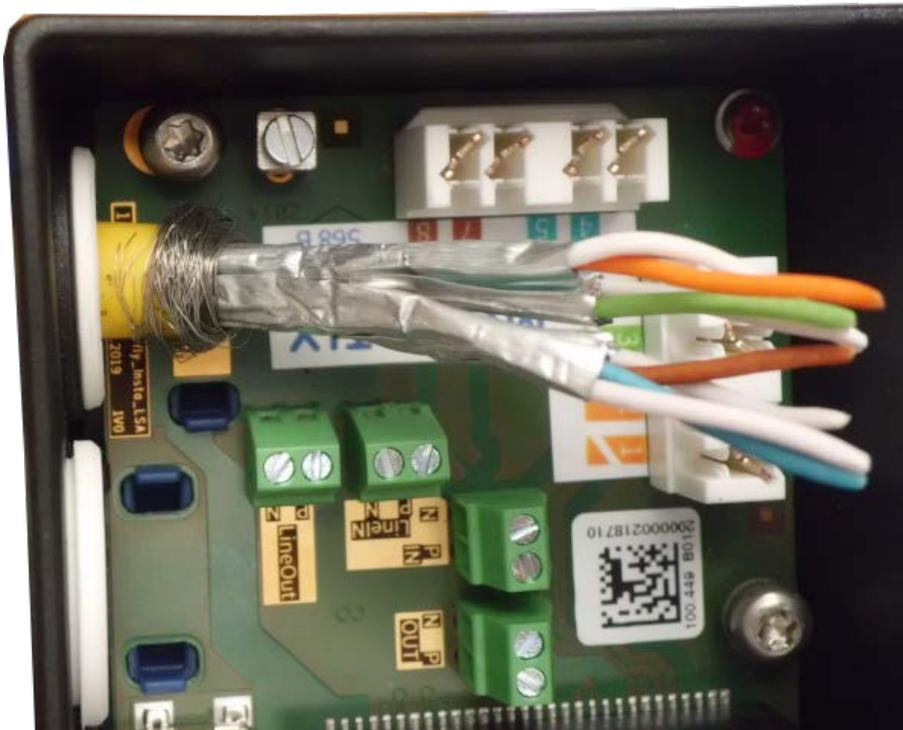
Fig. 60: Netzkabel eingesteckt, Stopfen richtig eingesetzt
