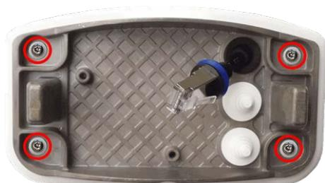
Fig. 36: Installiert und bereit für Connector Box RJ45
