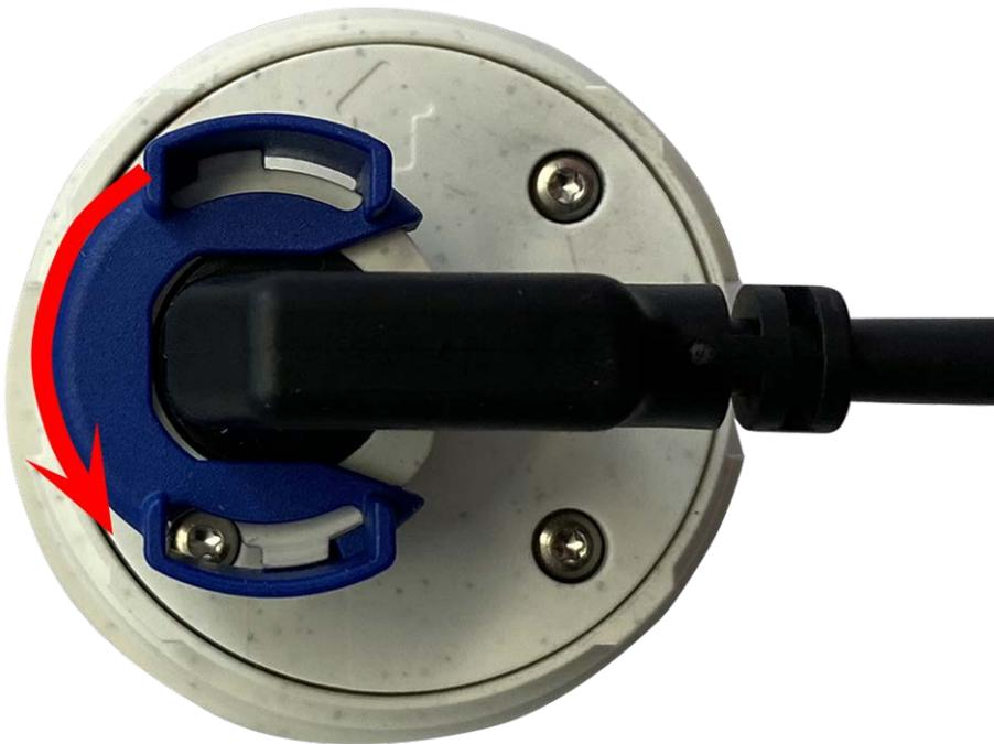
Fig. 20: Sensormodulkabel entriegeln
