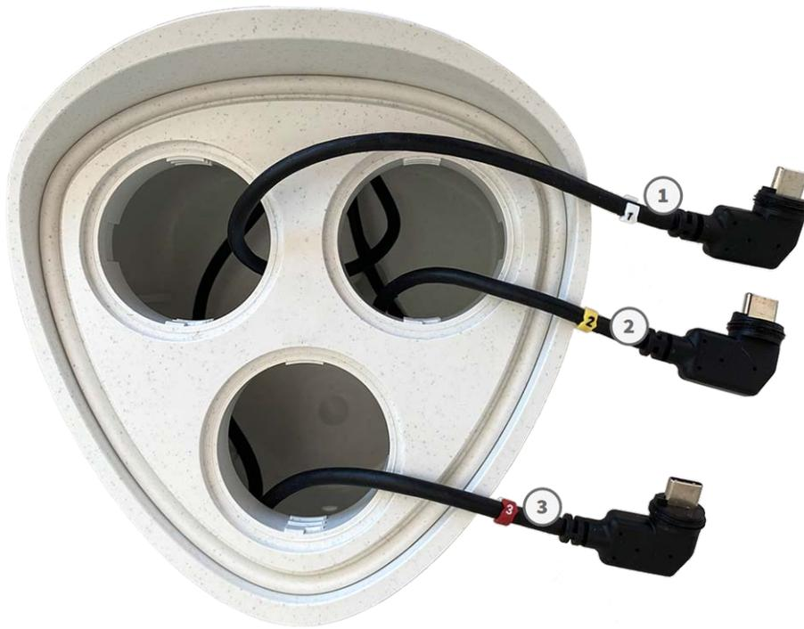
Fig. 8: Nummerierte Sensormodulkabel
