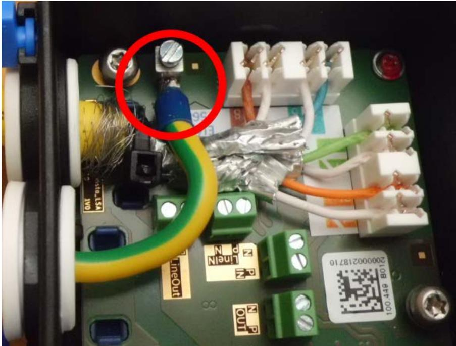
Fig. 66: Masseleitung mit Klemme verbunden
