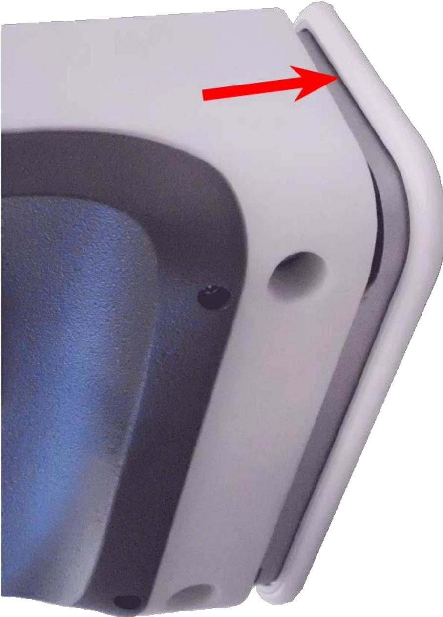
Fig. 69: Kamera auf Montageplatte drücken
