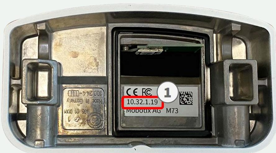
Fig. 5: IP-Adresse auf der Rückseite des Kameragehäuses
