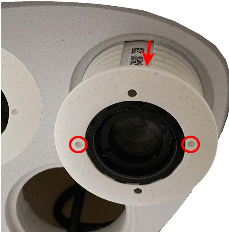
Fig. 23: Sensormodul aus Modulgehäuse entfernen
