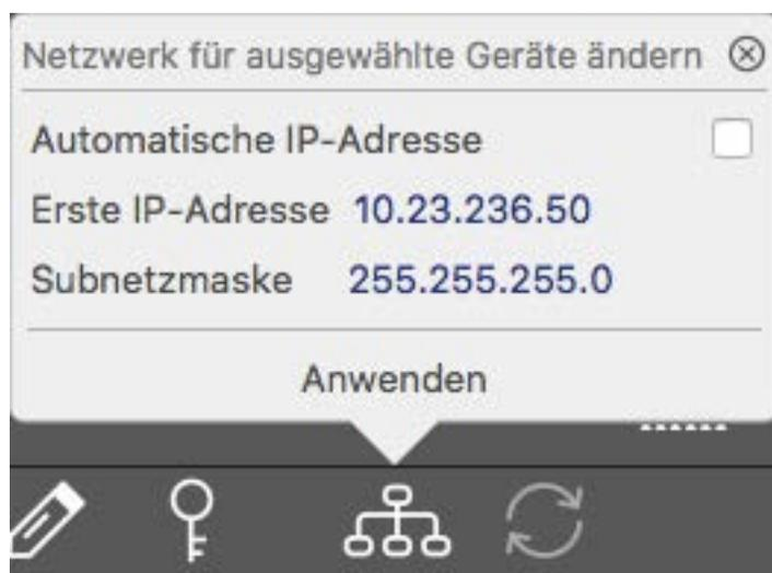
Fig. 80: Ändern der Netzwerkeinstellungen für ausgewählte Systeme
