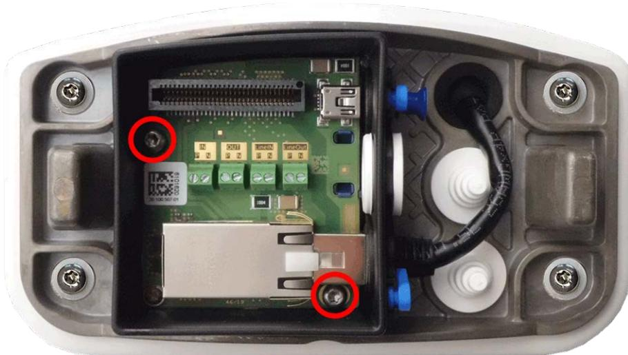
Fig. 55: Connector Box RJ45 (Draufsicht) mit zwei Schrauben (rot hervorgehoben) an Montageplatte montieren
