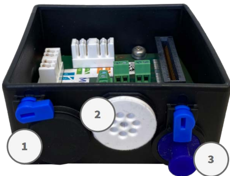
Fig. 56: Connector Box LSA con tapón de caucho negro C.3 ① , tapón de caucho de un solo cable C.4 ② , tapón para USB ③ y dos cierres azules
