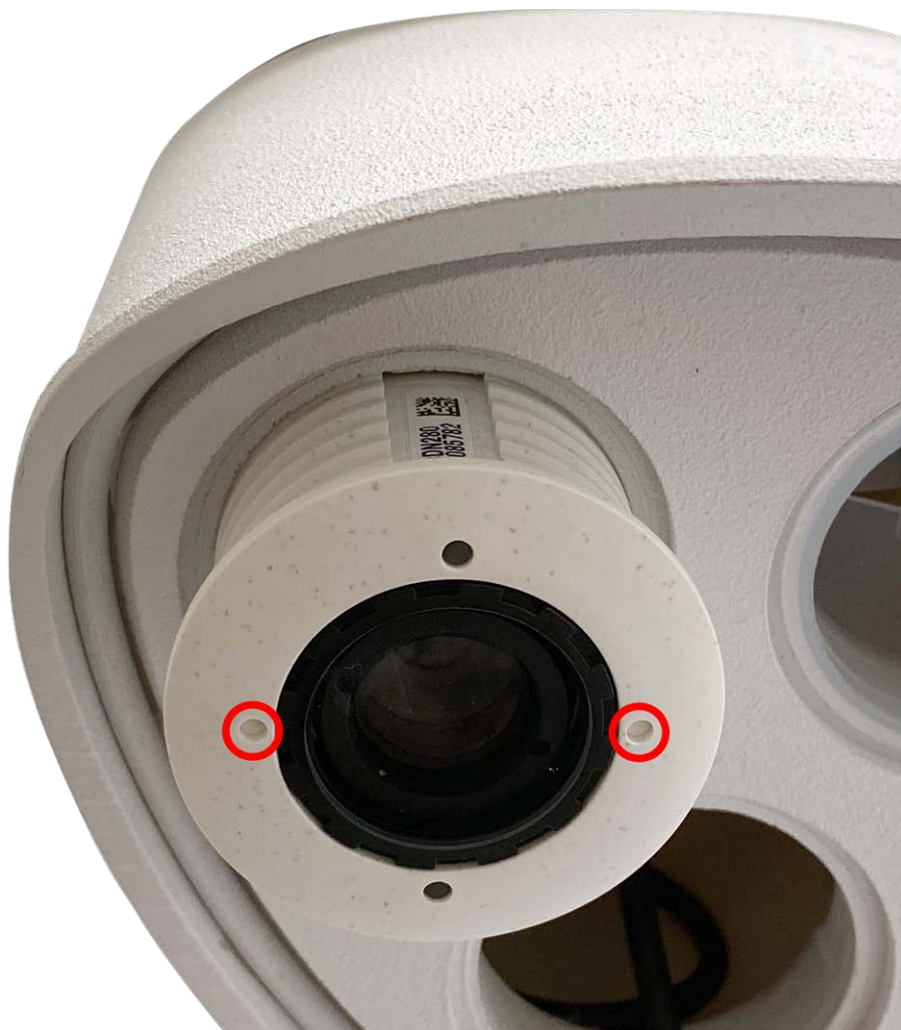
Fig. 12: Inserte el módulo de sensor en la carcasa del módulo
