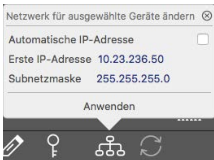
Fig. 80: Cambiar red para los dispositivos seleccionados
