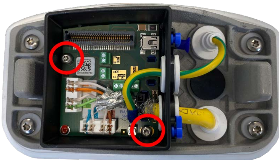
Fig. 67: Monte el Connector Box LSA (imagen superior) con los dos tornillos (resaltados en rojo) en la placa de montaje
