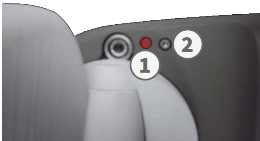
Fig. 74: Vista de la M73 desde abajo con el LED ① y el tornillo con sellado ② que oculta la llave dentro del chasis de la cámara
