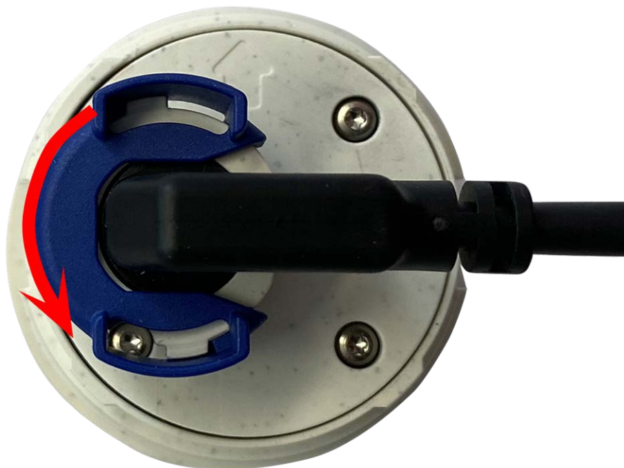
Fig. 20: Desbloqueo del cable del módulo de sensor
