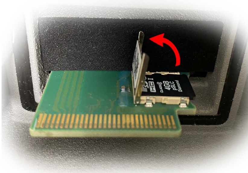
Fig. 95: Desbloquee el soporte de la tarjeta microSD
