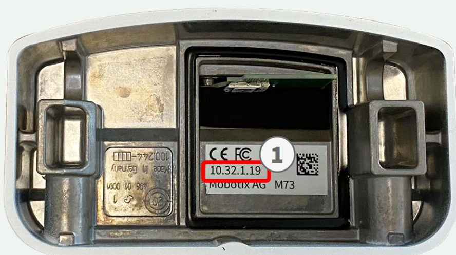
Fig. 5: Adresse IP au dos du boîtier de la caméra
