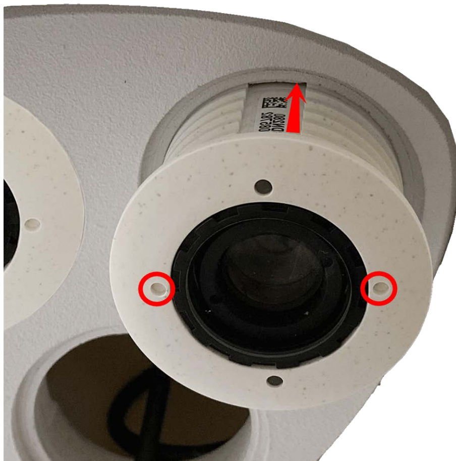
Fig. 25: Insérez le module de capteur dans la plaque avant thermique
