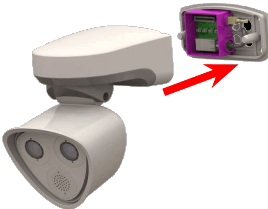
Fig. 68: Fixez la caméra sur la plaque de montage pour terminer le montage de la caméra
