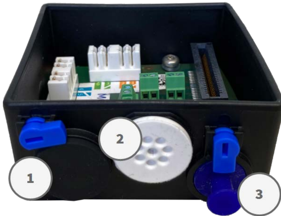
Fig. 57: Connector Box LSA con tappo in gomma nero C.3 ① , tappo in gomma a filo singolo C.4 ② , tappo USB ③ e due fermi blu
