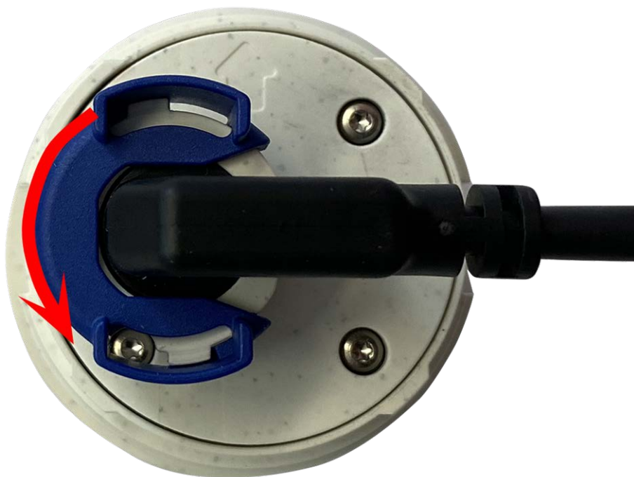
Fig. 21: Sbloccare il cavo del modulo sensore
