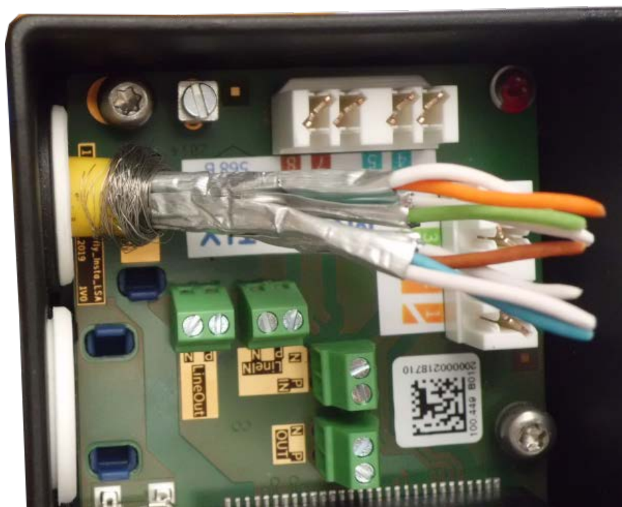
Fig. 61: Cavo di rete inserito, tappo posizionato correttamente
