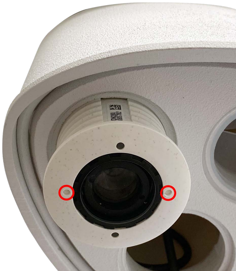
Fig. 13: Inserire il modulo sensore nell'apposito alloggiamento
