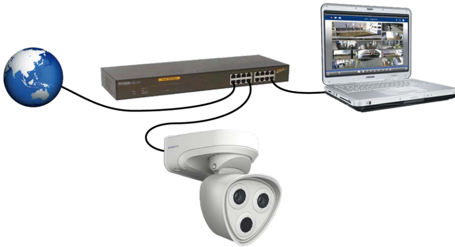
Fig. 53: Alimentazione tramite interruttore PoE in base allo standard PoE Plus (802.3at-2009)
