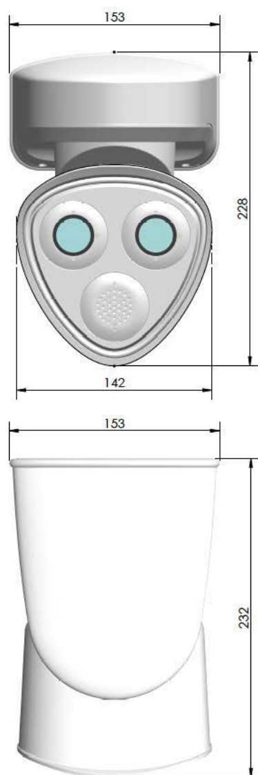
Fig. 5: M73: Tutte le misurazioni in mm
