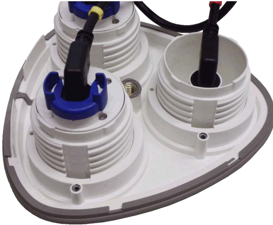
Fig. 16: Piastra anteriore predefinita con moduli sensore (retro)
