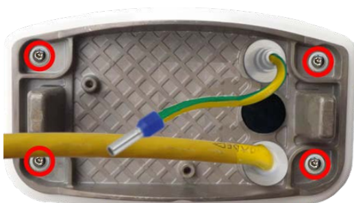
Fig. 59: Piastra di montaggio con filo di massa e cavo di rete
