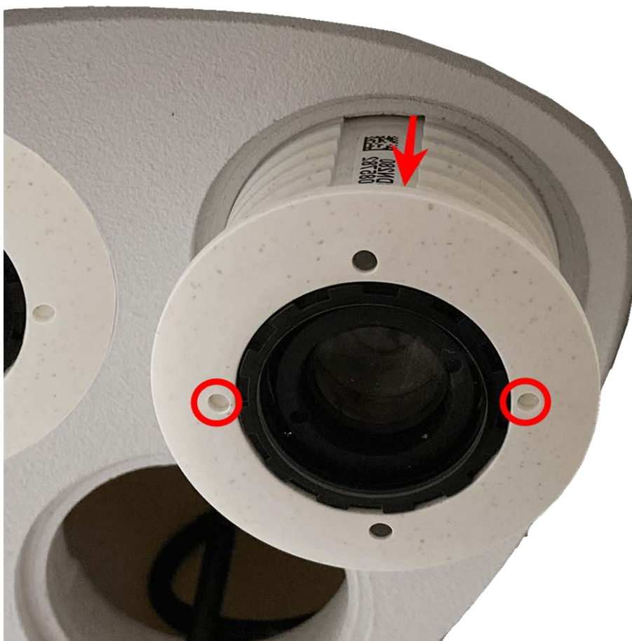
Fig. 24: Rimuovere il modulo sensore dall'alloggiamento del modulo
