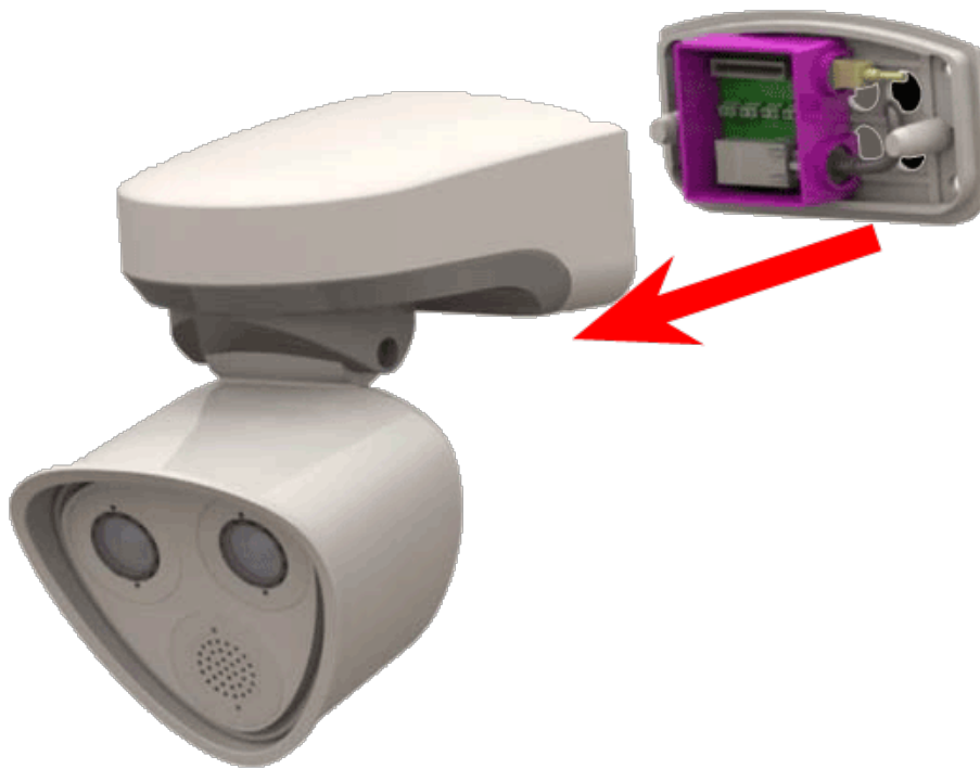
Fig. 94: Estrarre il corpo della telecamera dalla piastra di montaggio
