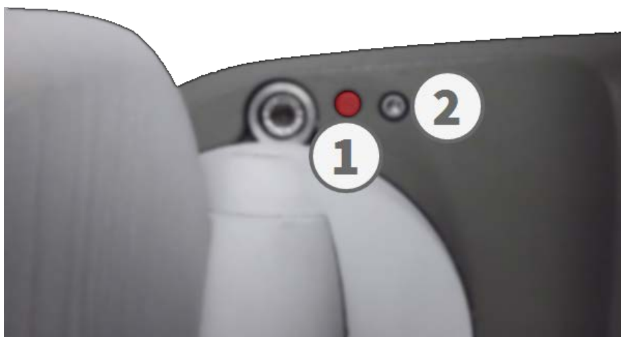
Fig. 75: Vista della M73 dal basso con LED ① e vite con guarnizione ② che nasconde il tasto all'interno del corpo della telecamera
