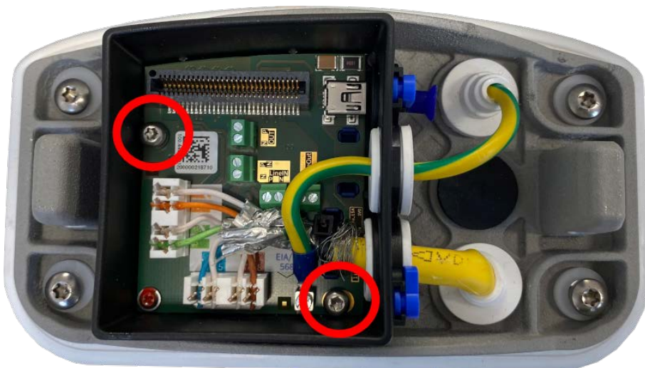
Fig. 68: Montare la Connector Box LSA (vista dall'alto) utilizzando le due viti (evidenziate in rosso nella figura) sulla piastra di montaggio
