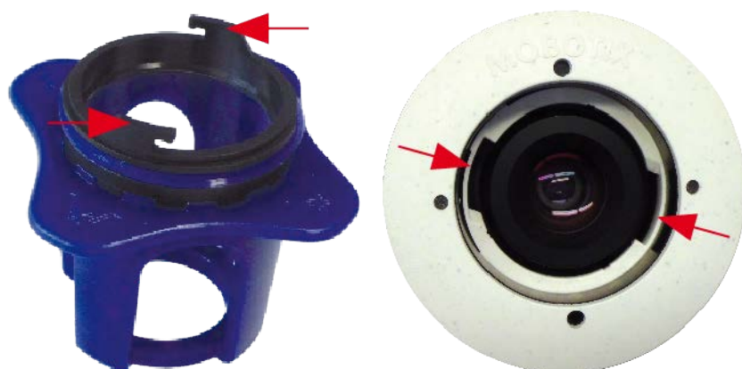
Fig. 86: Inserire il vetro di protezione dell'obiettivo utilizzando la chiave obiettivo
