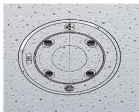
5. Bohren Sie in der Mitte der Bohrschablone ein weiteres Loch in die Wand oder Blende für das Kabel des Sensormoduls. Die Bohrung sollte einen Durchmesser zwischen 15 und 35 mm haben.
