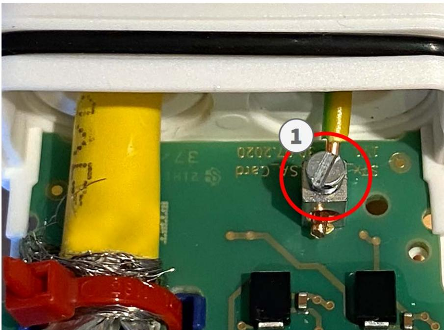
**Fig. 29: Masseleitung mit Klemme verbunden**
