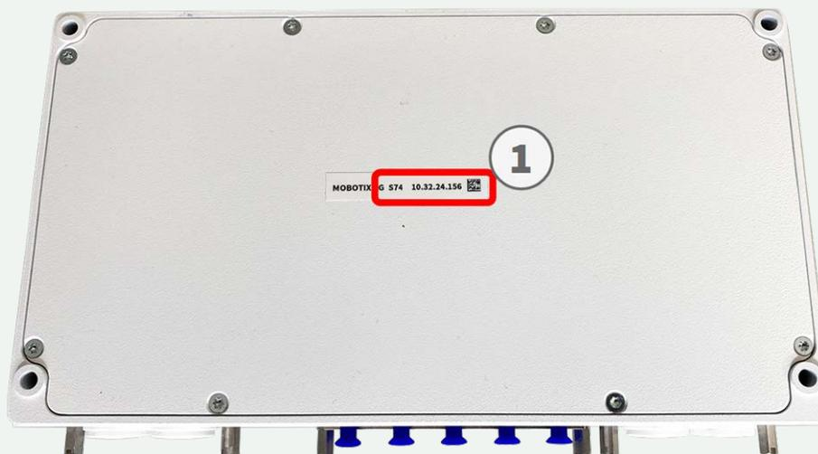
Fig. 8: IP-Adresse auf der Rückseite des Kameragehäuses
