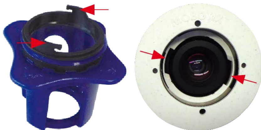
Fig. 47: Inserte el cristal de protección del objetivo con la llave de objetivo
