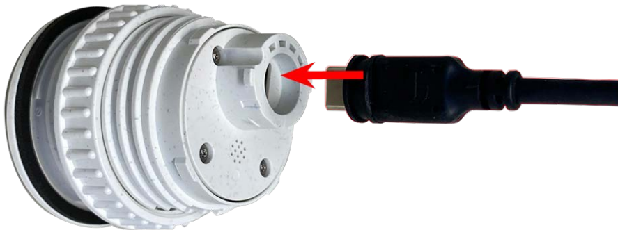
Fig. 11: Conecte el cable del módulo del sensor
