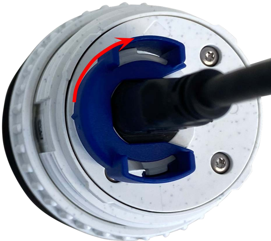
Fig. 12: Bloquee el cable del módulo del sensor
