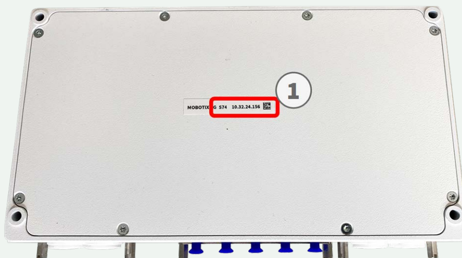
Fig. 8: Dirección IP en la parte posterior de la carcasa de la cámara
