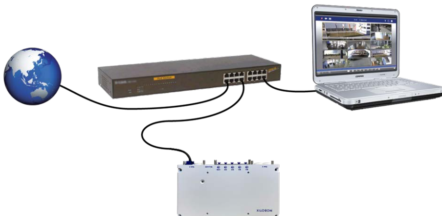
Fig. 34: Alimentation électrique à l'aide d'un commutateur PoE conformément à PoE Plus (802.3at-2009)
