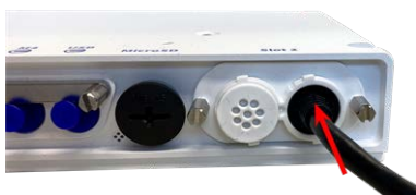
Fig. 35: Appuyez fermement sur la fiche jusqu'à ce que la bague d'étanchéité bleue s'enclenche
