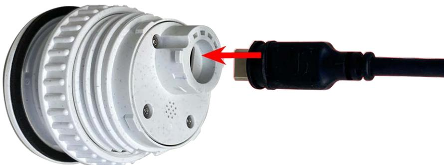
Fig. 11: Collegare il cavo del modulo sensore
