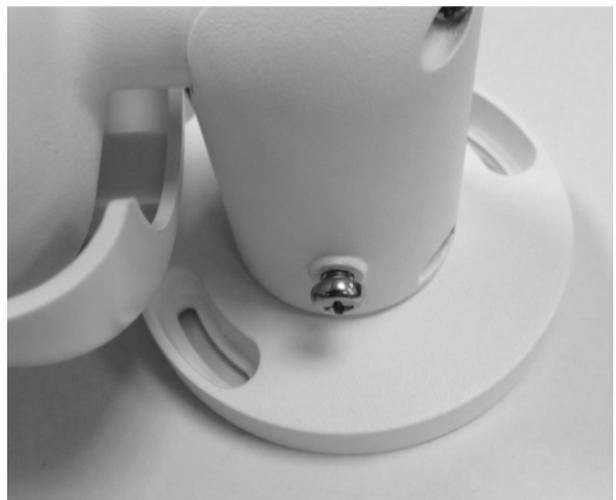
2. Se i fori delle viti sono bloccati dal corpo della telecamera, allentare la vite mostrata nella figura a destra senza rimuoverla. Quindi, ruotare il corpo della telecamera per raggiungere i fori delle viti.
