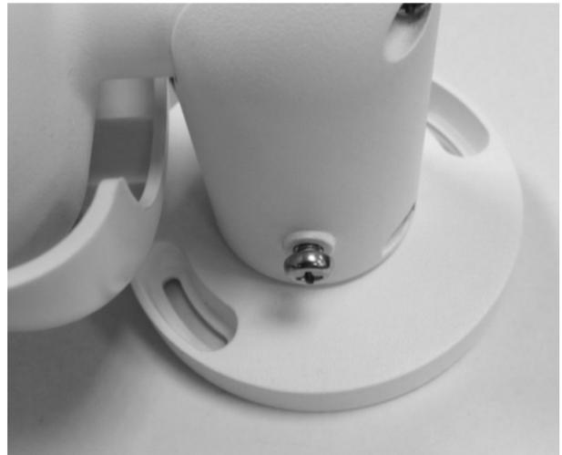
2. Si les trous de vis sont bloqués par le boîtier de la caméra, desserrez la vis indiquée sur la figure de droite sans la détacher. Faites ensuite pivoter le boîtier de la caméra pour atteindre les trous de vis.
