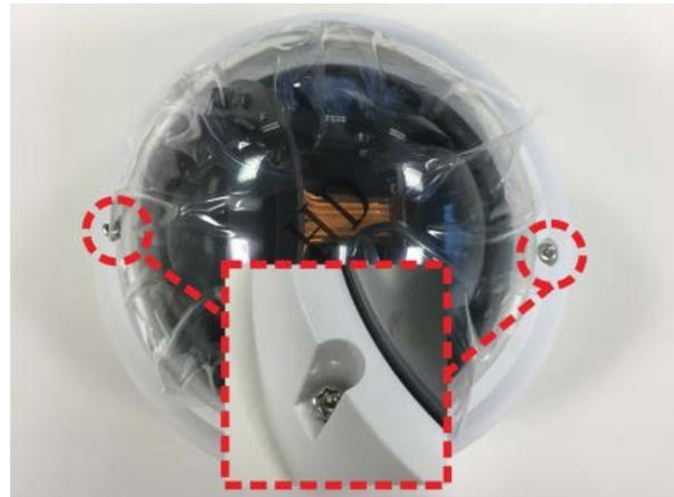
2. Ouvrez le bloc d'entrée du conduit arrière à l'aide d'une pièce de monnaie et placez-le sur l'entrée du conduit latéral.
