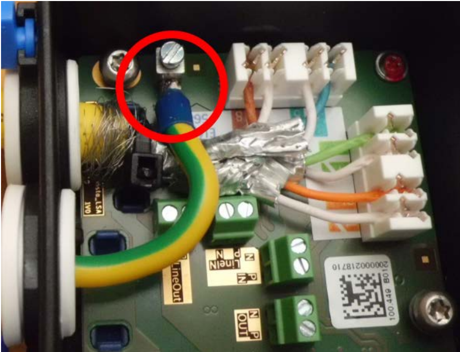
Abb. 62: Masseleitung mit Klemme verbunden
