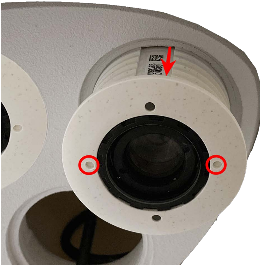
Abb. 23: Sensormodul aus Modulgehäuse entfernen
