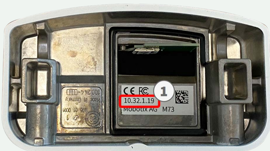
Abb. 5: IP-Adresse auf der Rückseite des Kameragehäuses
