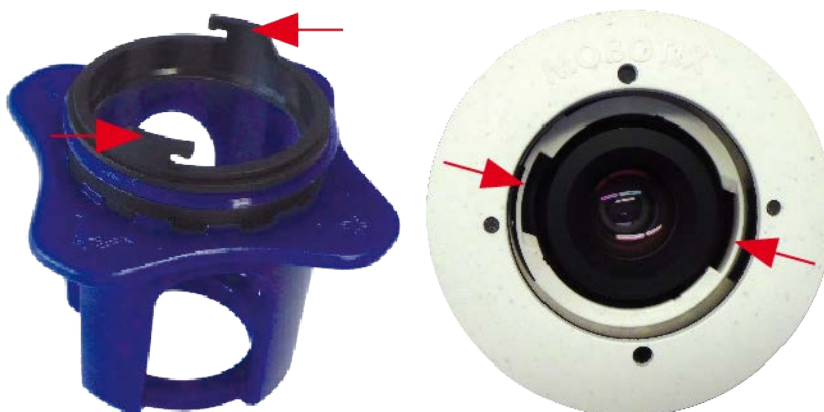
Abb. 84: Einsetzen des Schutzglases mit dem Linsenschlüssel
