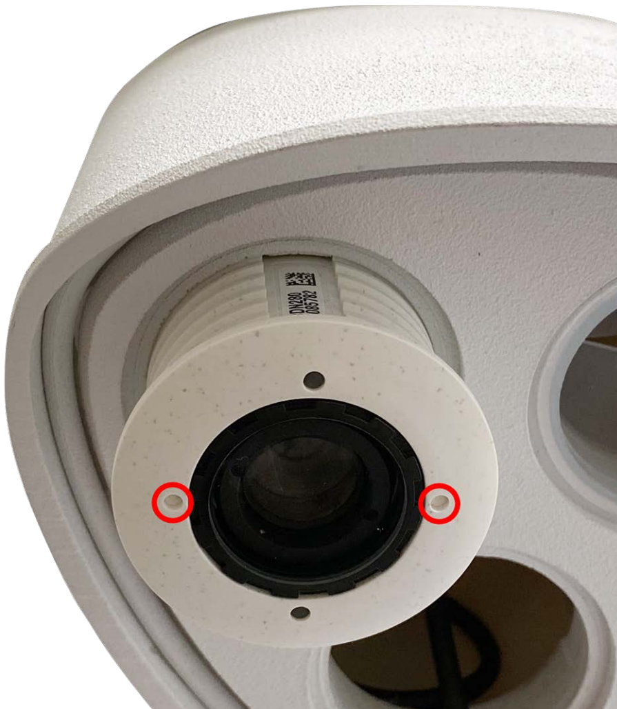
Abb. 12: Sensormodul in Modulgehäuse einsetzen
