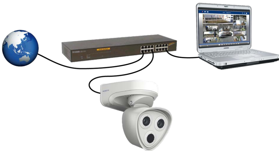
Abb. 51: Stromversorgung über PoE-Switch gemäß PoE Plus (802.3at-2009).
