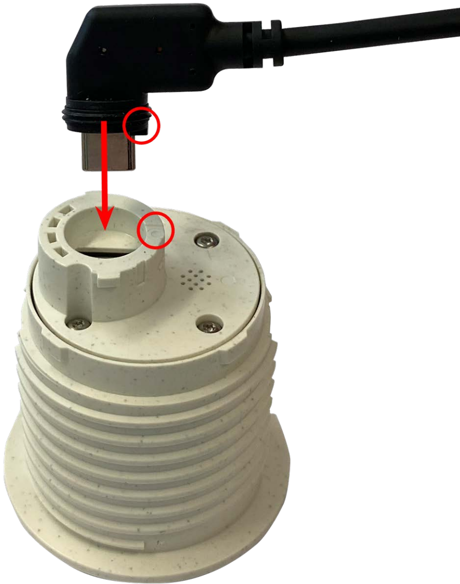
Abb. 27: Anschließen des Sensormodulkabels
