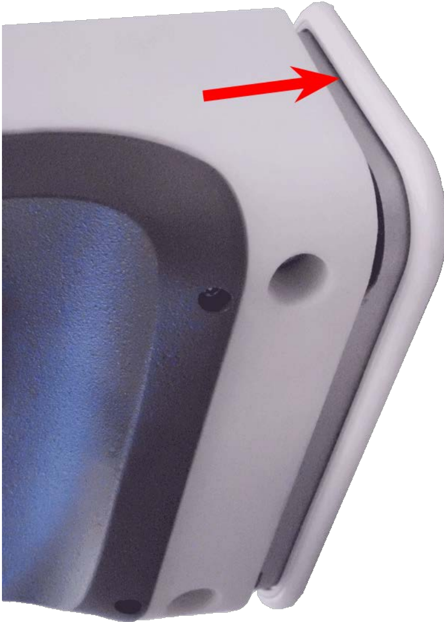
Abb. 68: Kamera auf Montageplatte drücken
