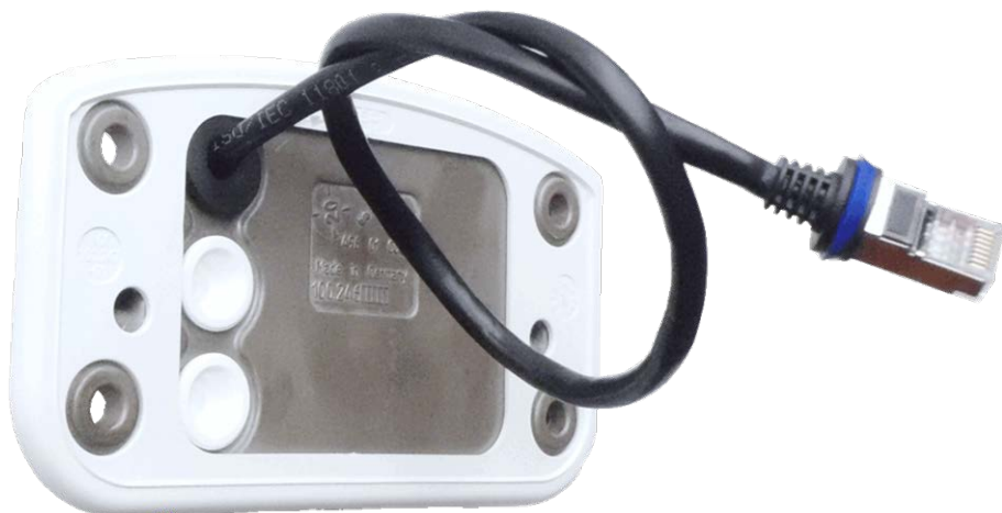
Abb. 32: Netzwerkanschluss der M73
