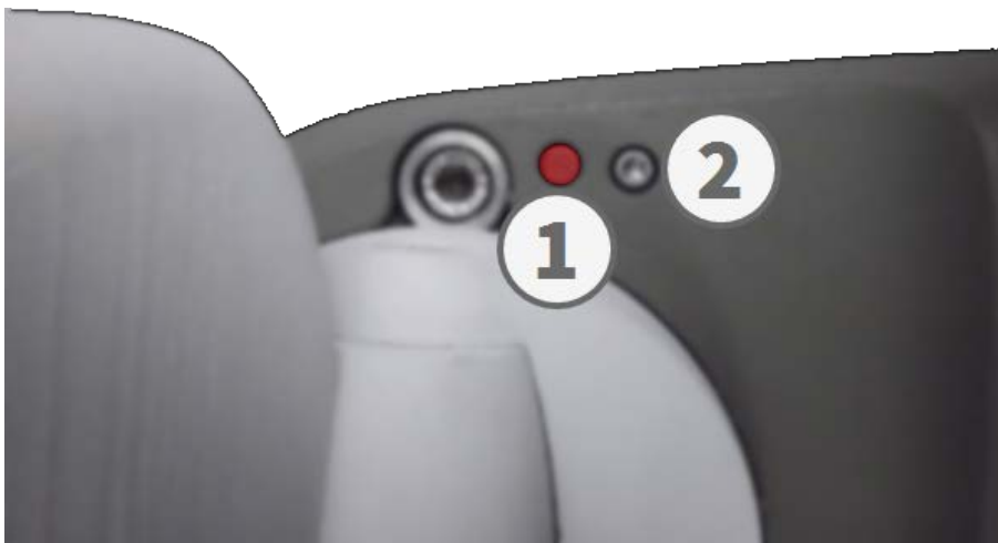
Abb. 73: Ansicht der M73 von unten mit LED ① und Schraube mit Dichtung ②, die die Taste im Kameragehäuse verbirgt
