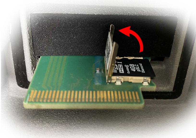
Abb. 93: Entriegeln des microSD-Kartenhalters
