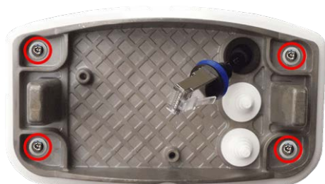
Abb. 36: Installiert und bereit für Connector Box RJ45
