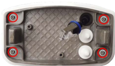
Abb. 49: Installiert und bereit für Connector Box RJ45
