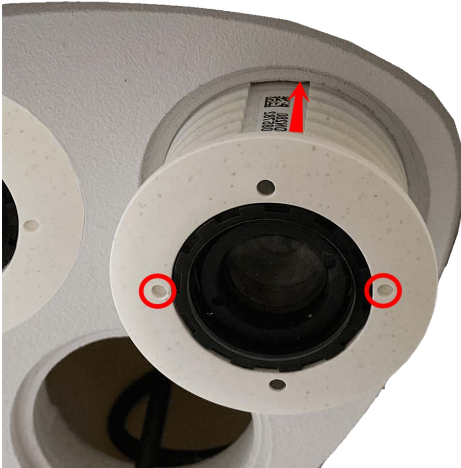
Abb. 25: Sensormodul in Thermal-Frontplatte einsetzen
