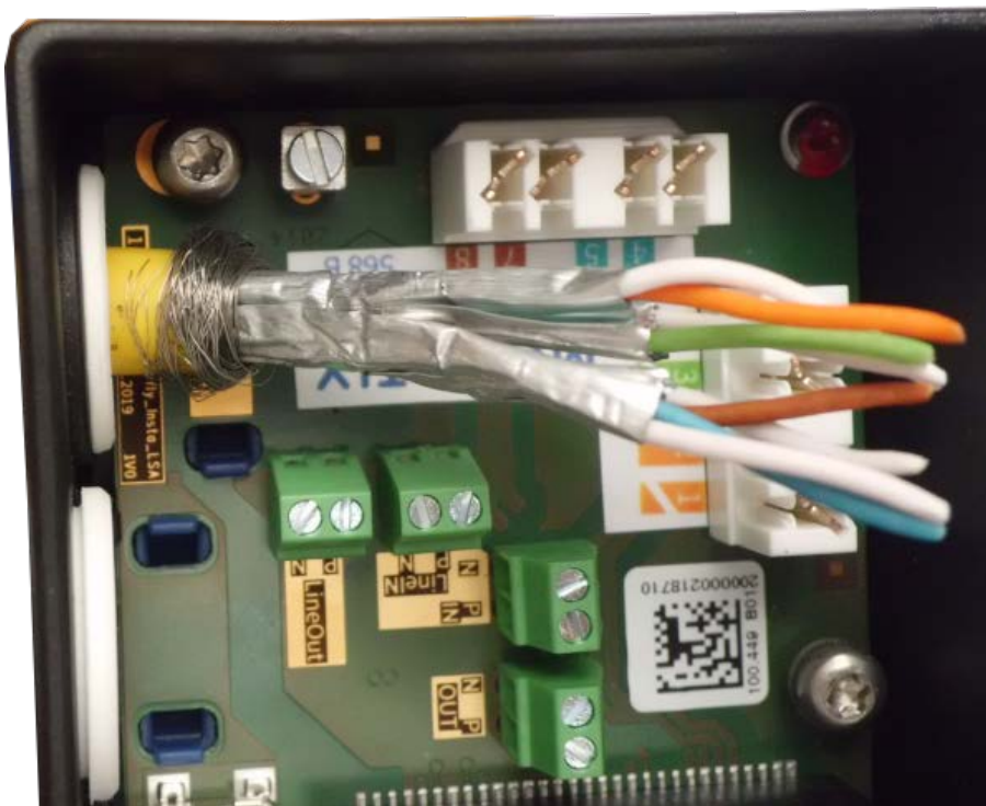
Abb. 56: Netzkabel eingesteckt, Stopfen richtig eingesetzt
