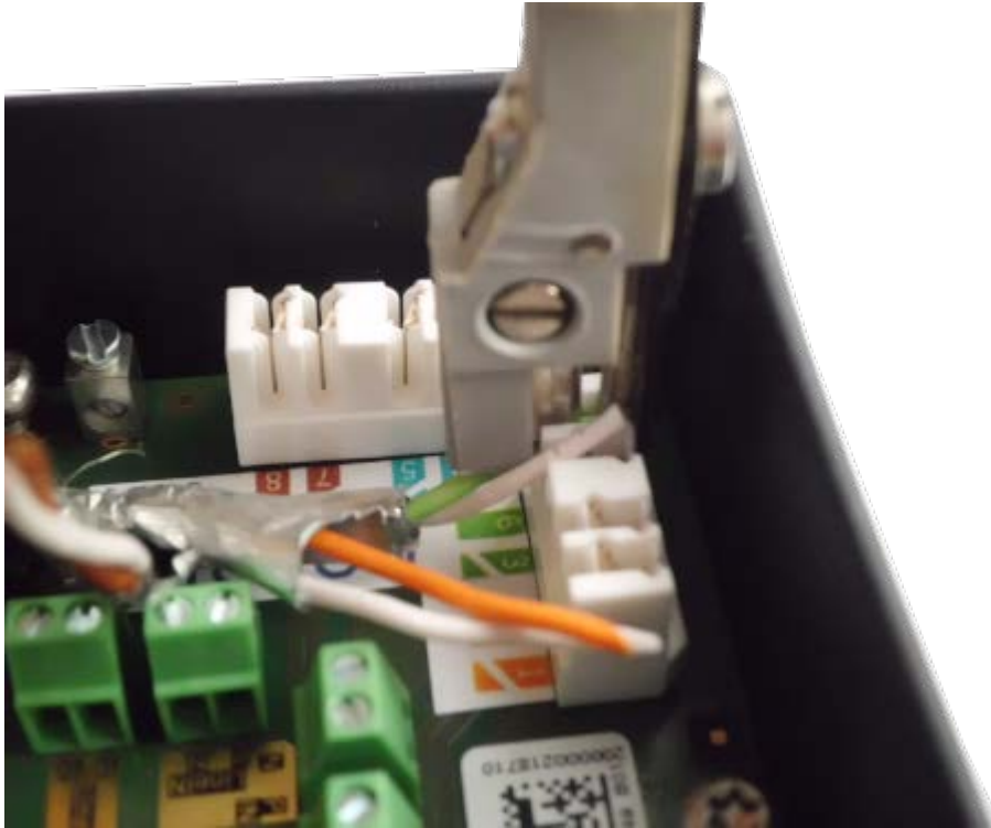
Abb. 59: Mit Krone LSA-Plus-Anlegewerkzeug angeschlossenes Netzkabel
