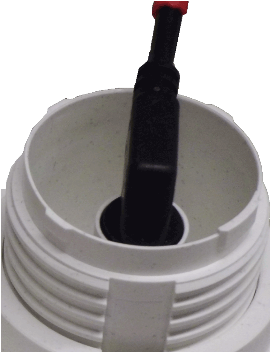
Abb. 10: Rückseite des Blindmoduls mit angeschlossenem Steckverbinder
