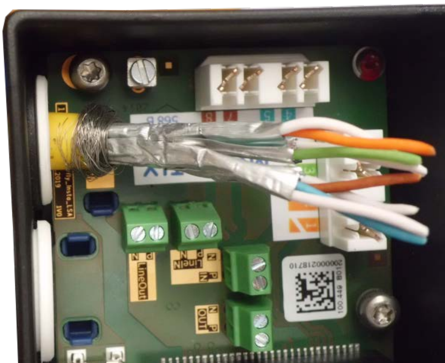
Fig. 56: El cable de red está introducido y el tapón, correctamente colocado
