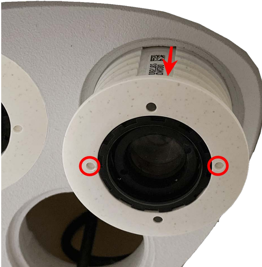
Fig. 23: Extracción del módulo de sensor desde la carcasa del módulo
