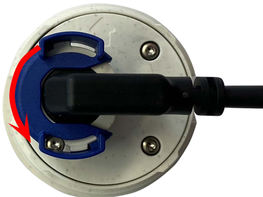
Fig. 20: Desbloqueo del cable del módulo de sensor
