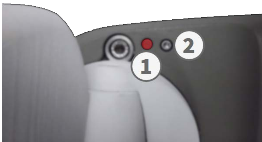
Fig. 73: Vista de la M73 desde abajo con el LED ① y el tornillo con sellado ② que oculta la llave dentro del chasis de la cámara
