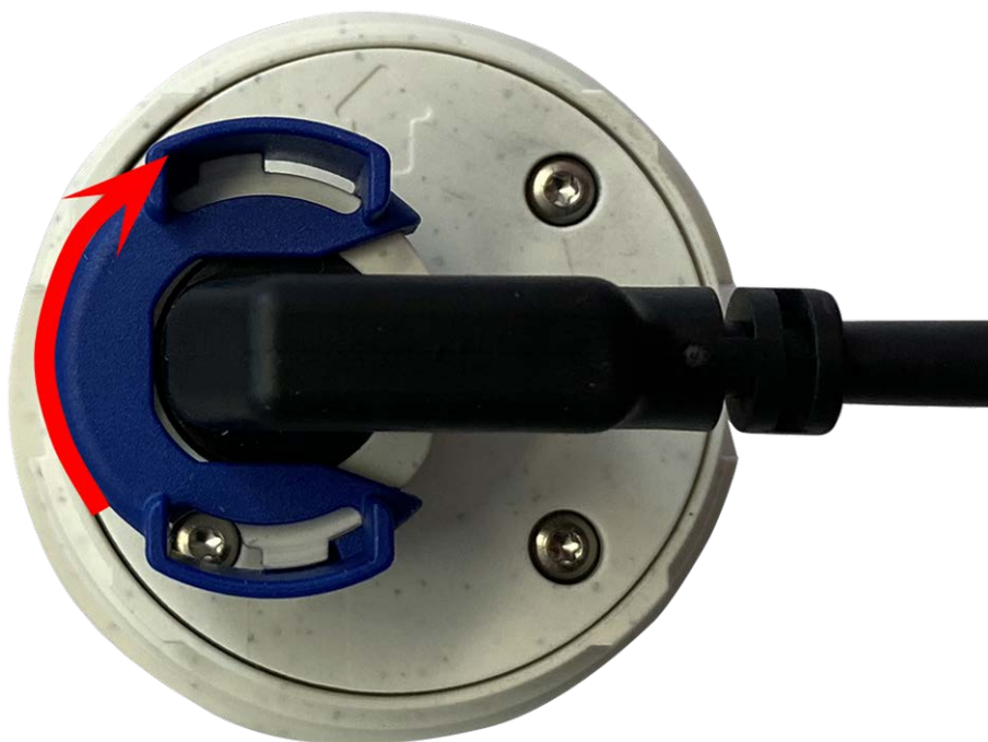
Fig. 28: Blocage du câble du module de capteur
