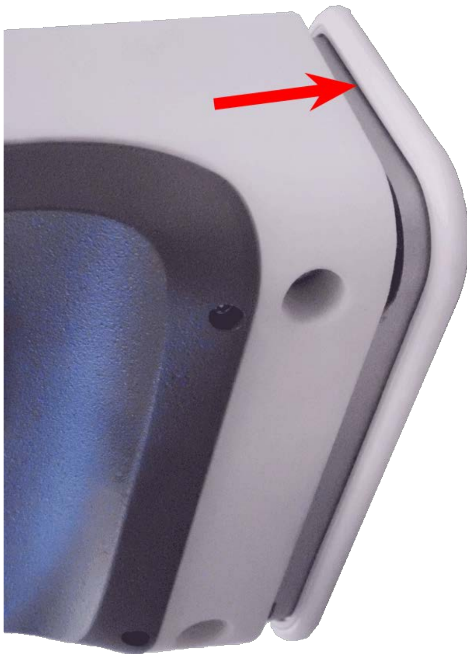
Fig. 68: Appuyez sur la caméra au niveau de la plaque de montage
