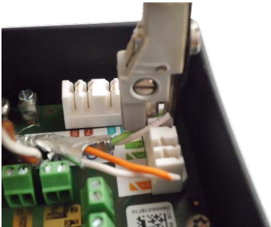
Fig. 59: Fils réseau connectés à l'aide de l'outil LSA+/Krone
