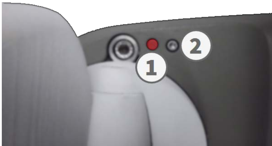
Fig. 73: Vue de la M73 du dessous avec voyant ① et vis avec joint ② qui masque la clé à l'intérieur du boîtier de la caméra
