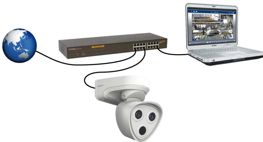
Fig. 51: Alimentation électrique à l'aide d'un commutateur PoE conformément à PoE Plus (802.3at-2009).
