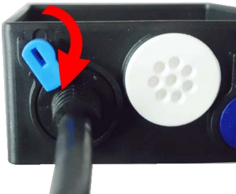
Fig. 65: Bloquez le câble réseau dans le boîtier de connexion
