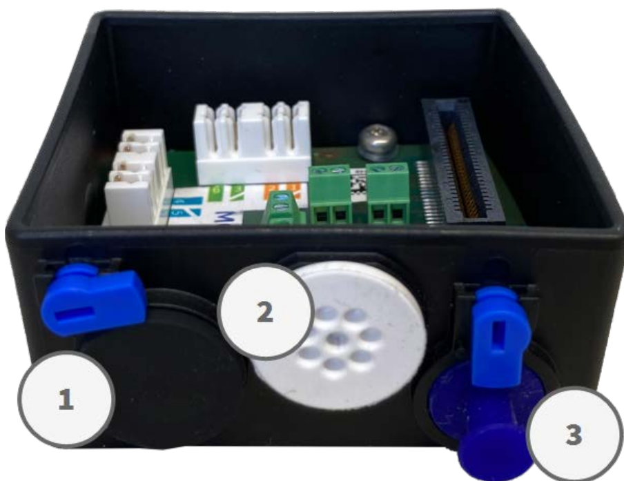
Fig. 52: Connector Box LSA avec bouchon en caoutchouc noir C.3 ①, bouchon en caoutchouc à un fil C.4 ②, prise USB ③ et deux verrous bleus
