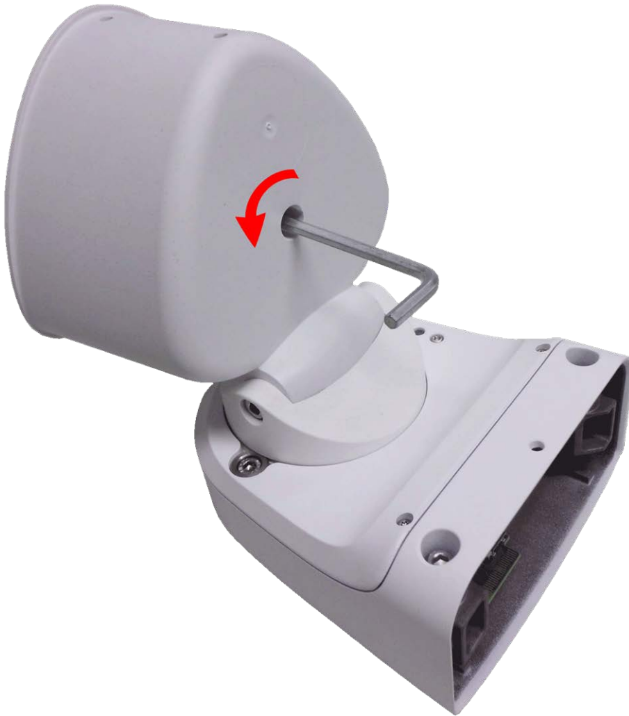
Fig. 14: Ouverture du boîtier du module
