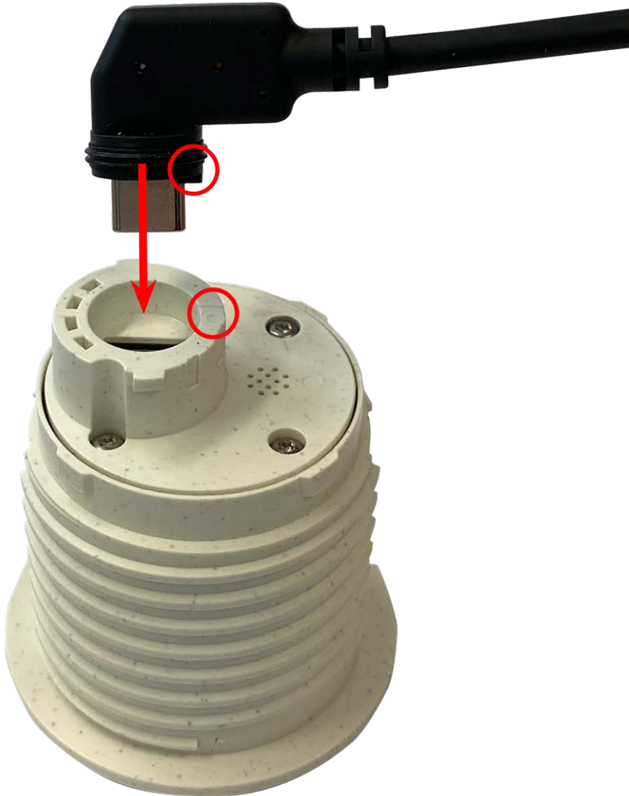
Fig. 9: Branchement du câble du module de capteur
