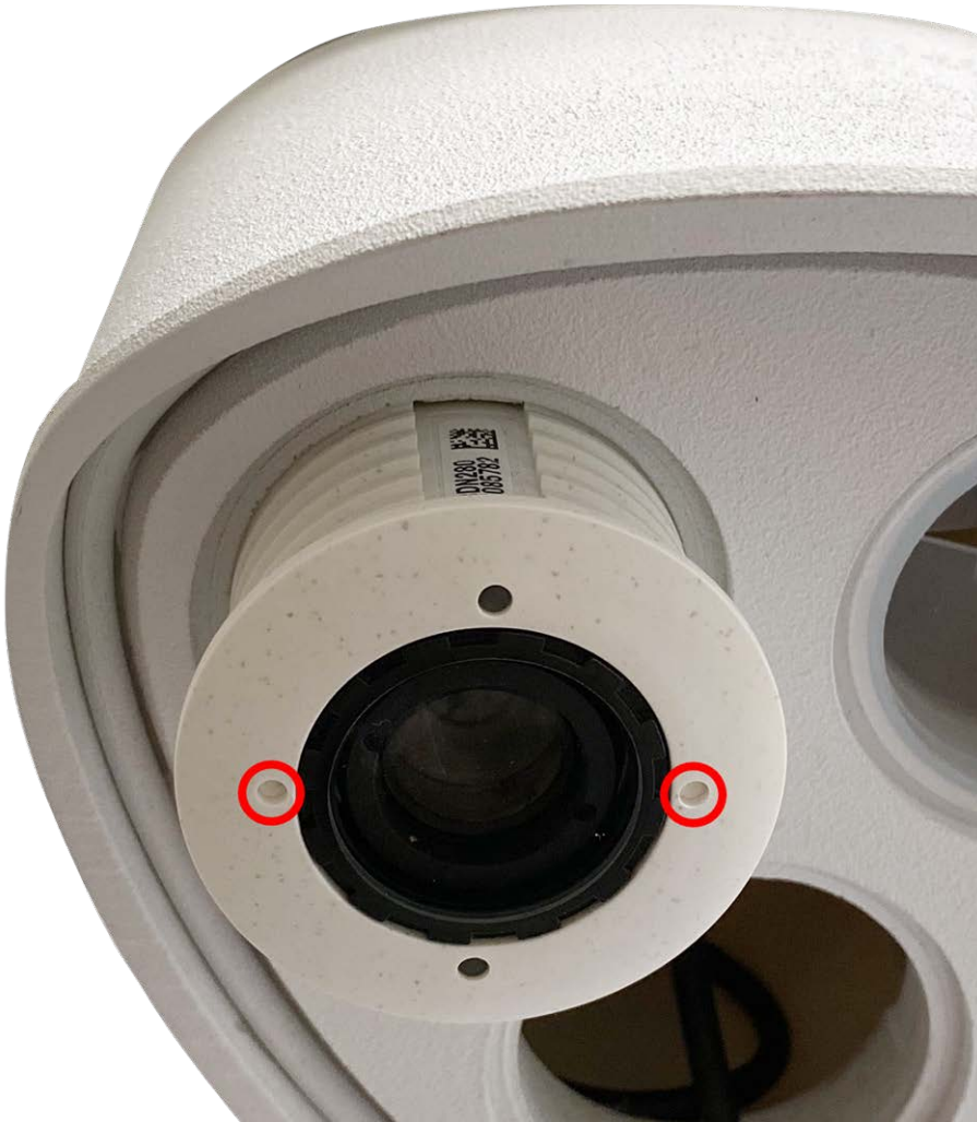
Fig. 22: Déverrouillez le module de capteur
