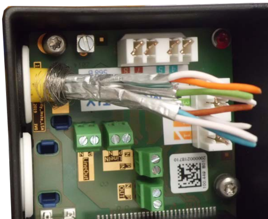
Fig. 56: Cavo di rete inserito, tappo posizionato correttamente
