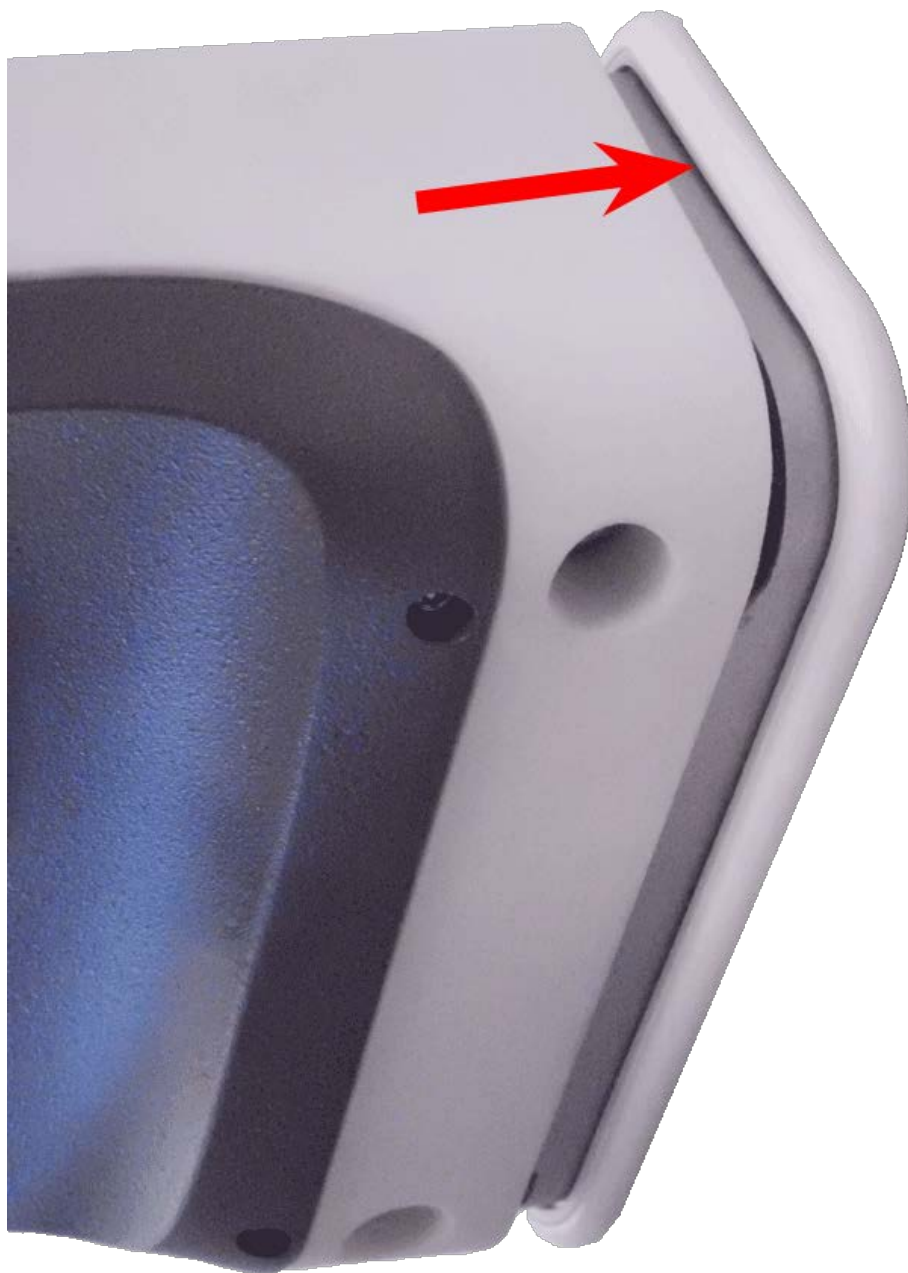
Fig. 68: Premere la telecamera sulla piastra di montaggio
