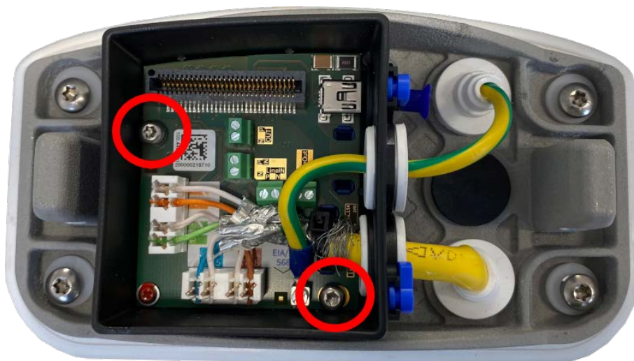
Fig. 63: Montare la Connector Box LSA (vista dall'alto) utilizzando le due viti (evidenziate in rosso nella figura) sulla piastra di montaggio
