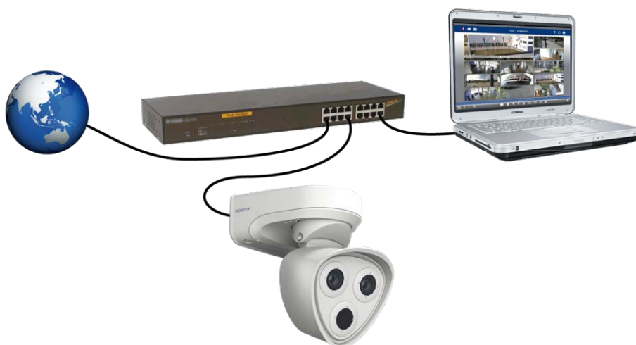
Fig. 51: Alimentazione tramite interruttore PoE in base allo standard PoE Plus (802.3at-2009).
