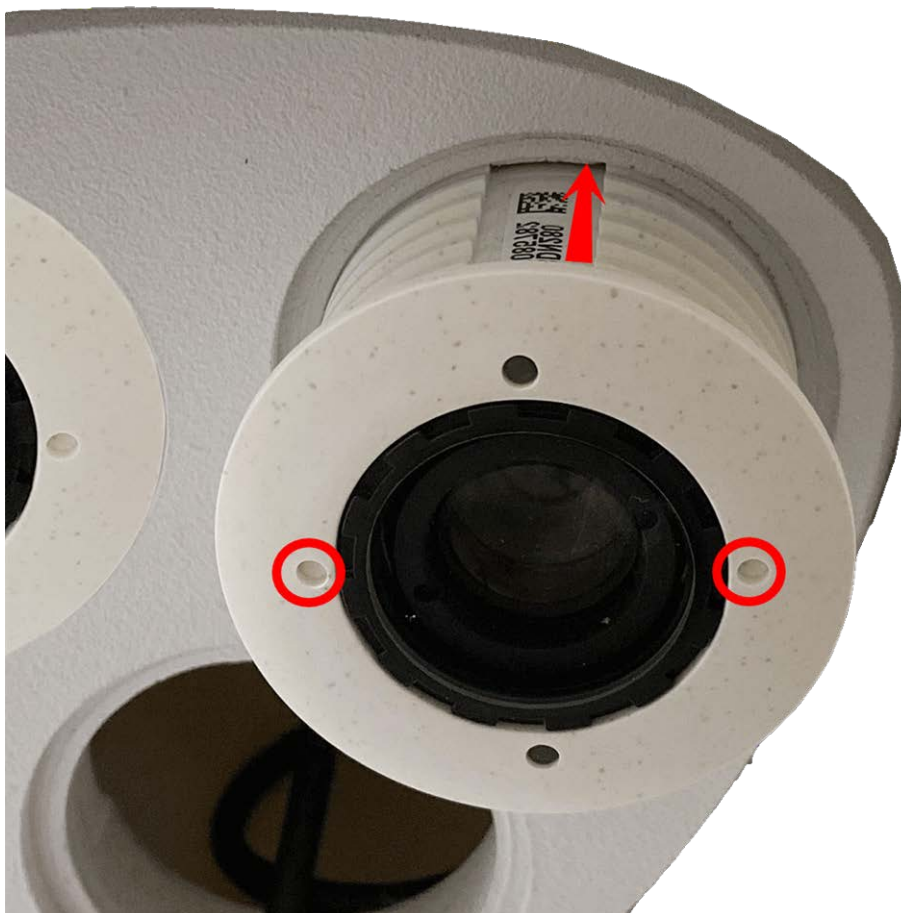
Fig. 25: Inserire il modulo sensore nella piastra anteriore Thermal
