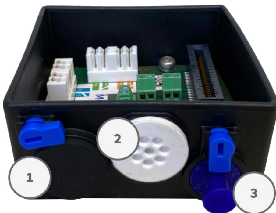
Fig. 52: Connector Box LSA con tappo in gomma nero C.3 ① , tappo in gomma a filo singolo C.4 ② , tappo USB ③ e due fermi blu
