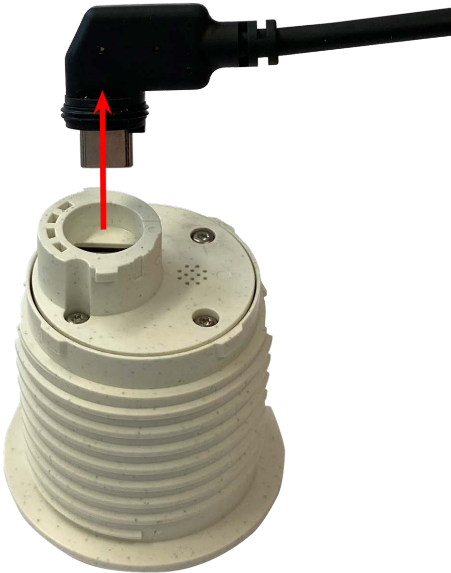
Fig. 21: Remove the sensor module cable
