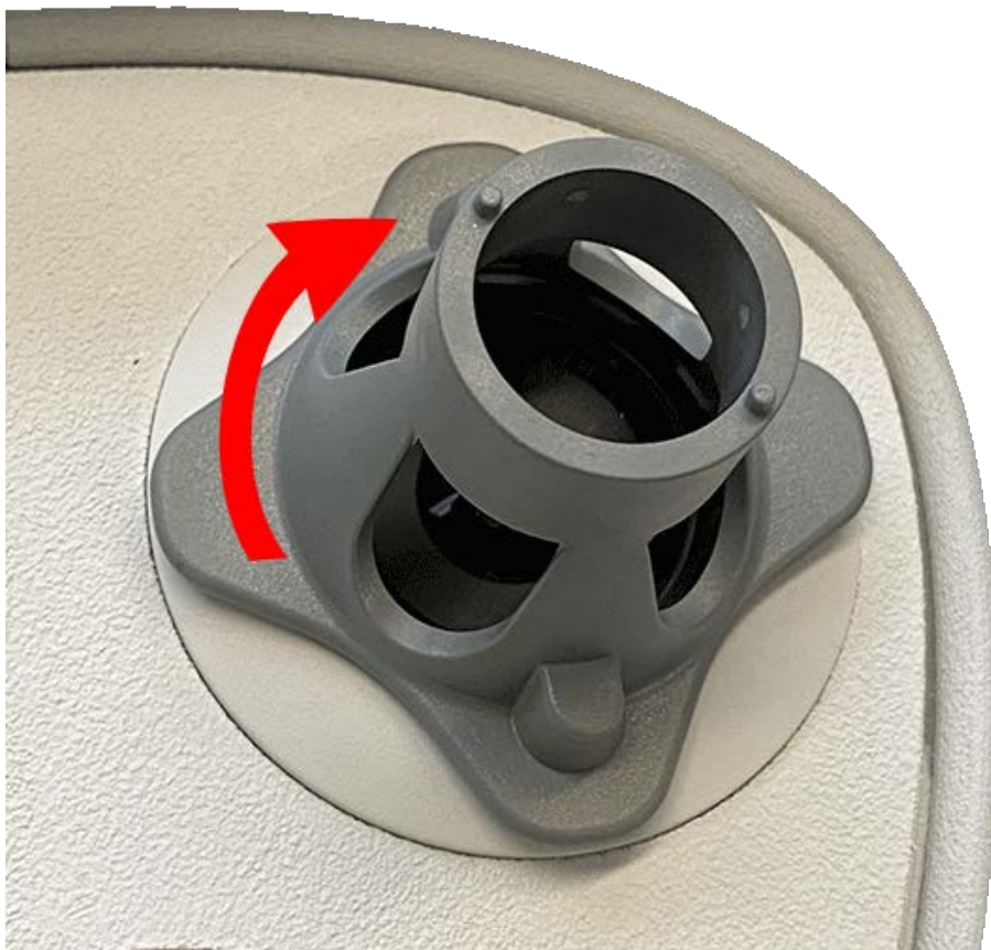
Fig. 26: Lock the sensor module
