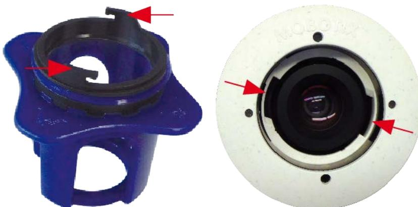
Abb. 47: Einsetzen des Schutzglases mit dem Linsenschlüssel
