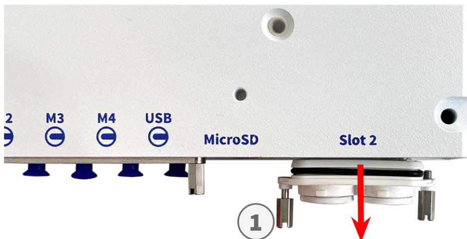
Abb. 22: Entfernen der Abdeckung vom Steckplatz der Schnittstellenkarte
