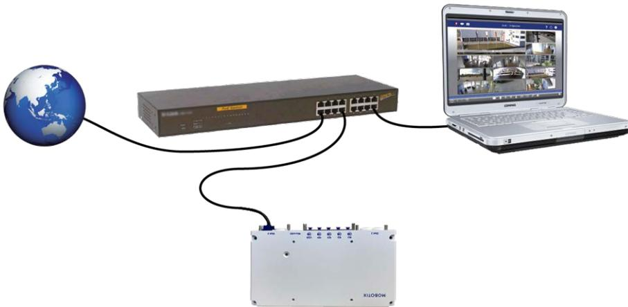
Abb. 34: Stromversorgung über PoE-Switch gemäß PoE Plus (802.3at-2009)
