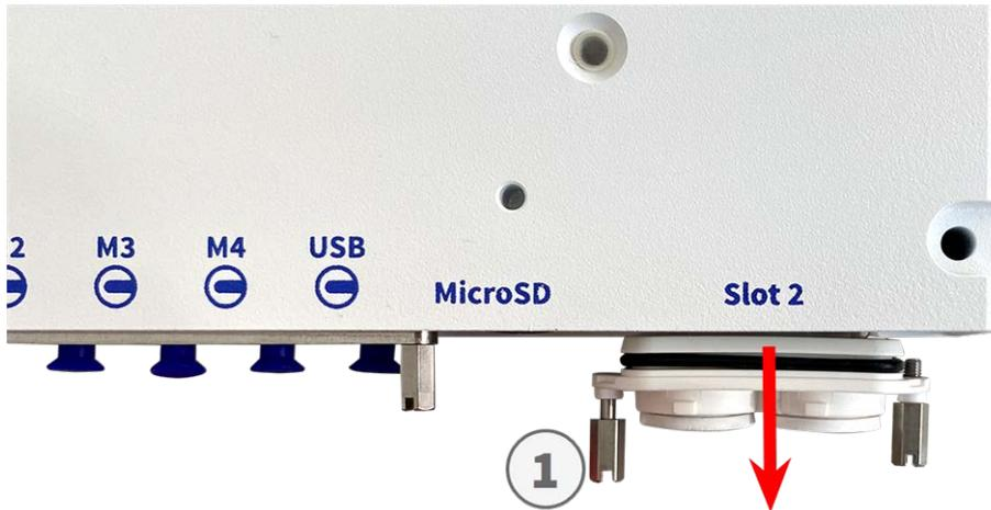
Abb. 18: Entfernen der Abdeckung vom Steckplatz der Schnittstellenkarte
