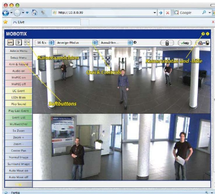
Abb. 49: Schnittstelle der Kamerasoftware
