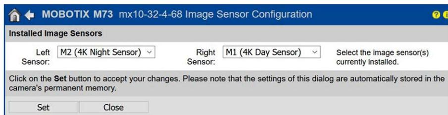
Abb. 50: Konfigurieren der Sensormodule
