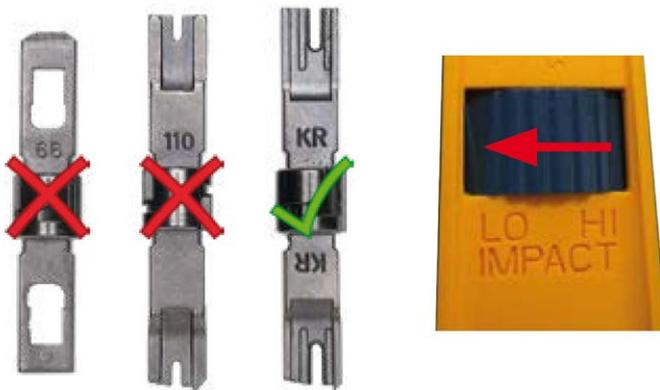
Abb. 25: Krone LSA-Plus-Anlegewerkzeug auf GERINGE Kraft eingestellt
