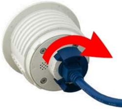
9. Schieben Sie das Sensormodul so in das PTMount, dass die **MOBOTIX**-Beschriftung im Vergleich zur Beschriftung **TOP/OBEN** um 90 Grad nach links gedreht ist.
