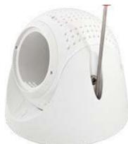
2. Entfernen Sie den Schwenkring und die Grundplatte.
