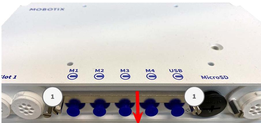
2. Entfernen Sie den blauen Gummistopfen ① vom Modulsteckverbinder.
