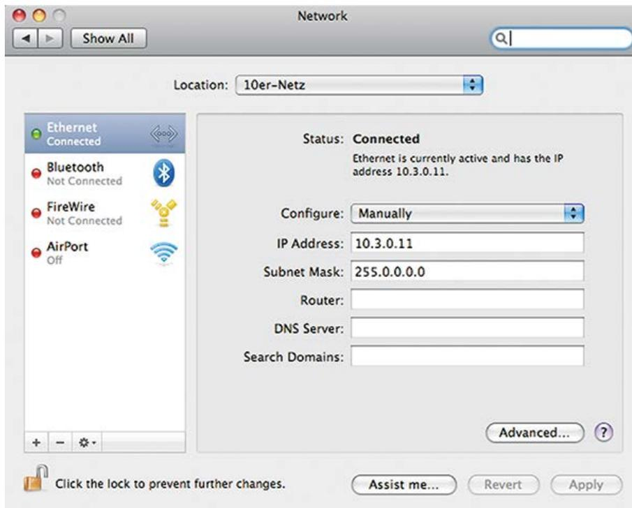
Fig. 39: Configuración de red en equipos MacOS
