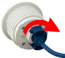
9. Presione el módulo de sensor en PTMount de modo que las letras que indican **MOBOTIX** giren 90 grados hacia la izquierda en comparación con las letras **TOP/OBEN**.
