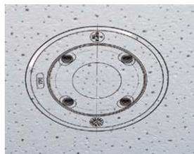
5. En el centro de la plantilla de perforación, taladre otro agujero en la pared o en la placa frontal para el cable del módulo de sensor. El agujero debe tener un diámetro entre 15 y 35 mm.
