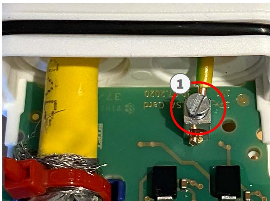
**Fig. 29: Cable de tierra conectado al borne**
