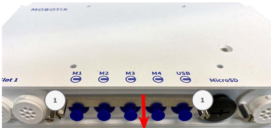
2. Retire el tapón de caucho azul ① del conector del módulo.
