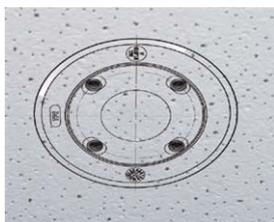
5. Au centre du gabarit de perçage, percez un autre trou dans le mur ou dans la plaque frontale pour le câble du module de capteur. Le diamètre du trou doit être compris entre 15 et 35 mm.
