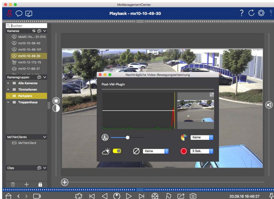
Fig. 94: Impostazione delle condizioni di attivazione
