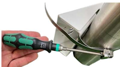
Fig. 13: Ajuste de las correas
