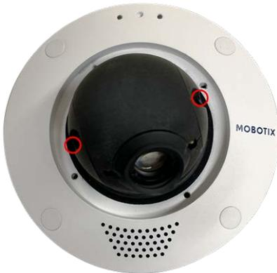
4. Orientez la caméra en faisant pivoter ① la monture d'objectif et en faisant un panoramique ② .
