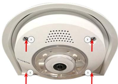
11. Insérez les bouchons en caoutchouc [M.7](#), p. 18 dans les trous de vis de la caméra (① et ② dans la figure ci-dessus).
