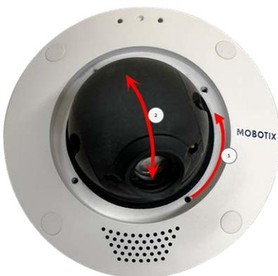
5. Serrez les deux vis Allen de part et d'autre de la monture d'objectif.
