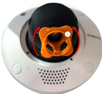
7. Si nécessaire, nettoyez les surfaces optiques à l'aide d'un chiffon en coton propre et non pelucheux.
