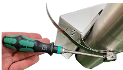
Fig. 13: Ajuste de las correas
