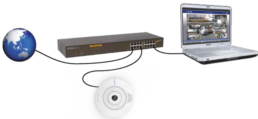
Fig. 15: Fuente de alimentación mediante un conmutador PoE según la PoE Plus (802.3at-2009)
