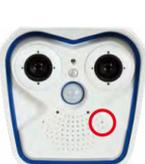
La DEL clignote une fois et répète le signal après une pause d'une seconde (la nombre des clignotements correspond à l'option de démarrage actuelle). Pressez brièvement avec le trombone (< 1 sec.) afin de basculer vers l'option de démarrage prochaine. Après la dernière option de démarrage dans le menu, la caméra recommencera avec la première option (un clignotement).
