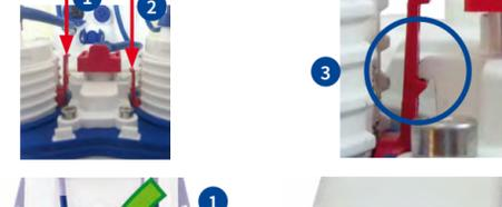
Posez la caméra comme indiqué sur le côté droit (dans la direction de la caméra) et placez l'élément frontal. En enfonçant l'élément frontal **2**, flèches rouges), veillez qu'aucun câble ne soit coincé.
