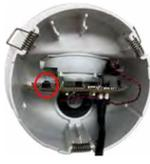
Die LED blinkt jetzt ein Mal und wiederholt dieses Blinksignal nach einer Pause von einer Sekunde (die Anzahl der Blinksignale entspricht der aktuell auswählbaren Boot-Option). Drücken Sie die Taste erneut kurz (< 1 s), um zur nächsten Boot-Option zu wechseln. Nach der letzten Boot-Option wird wieder die erste angezeigt (1 x blinken).
