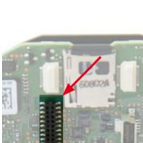
Stellen Sie sicher, dass das Mx-A-IOA-IC vollständig eingesteckt ist.
