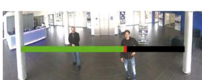
Drehen Sie das Objektiv mithilfe des grauen Objektivschlüssels vorsichtig hin und her, bis der rote Bereich der Scharfstellhilfe möglichst vollständig verschwunden ist. Nehmen Sie den Objektivschlüssel nach jedem Ändern der Schärfeneinstellung ab.
