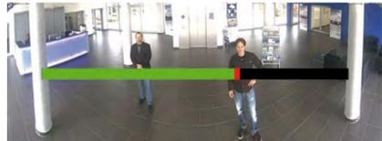
Faites pivoter doucement l'objectif d'un côté puis de l'autre à l'aide de la clé d'objectif grise, jusqu'à ce que la zone rouge de l'aide à la mise au point ait disparu autant que possible. Retirez la clé d'objectif après chaque modification du réglage de la netteté.
