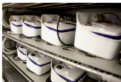
Jede Kamera wird vor der Auslieferung bei extremen Temperaturen getestet.
