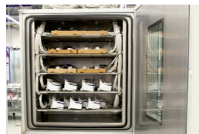
Jede Kamera wird vor der Auslieferung bei extremen Temperaturen getestet.
