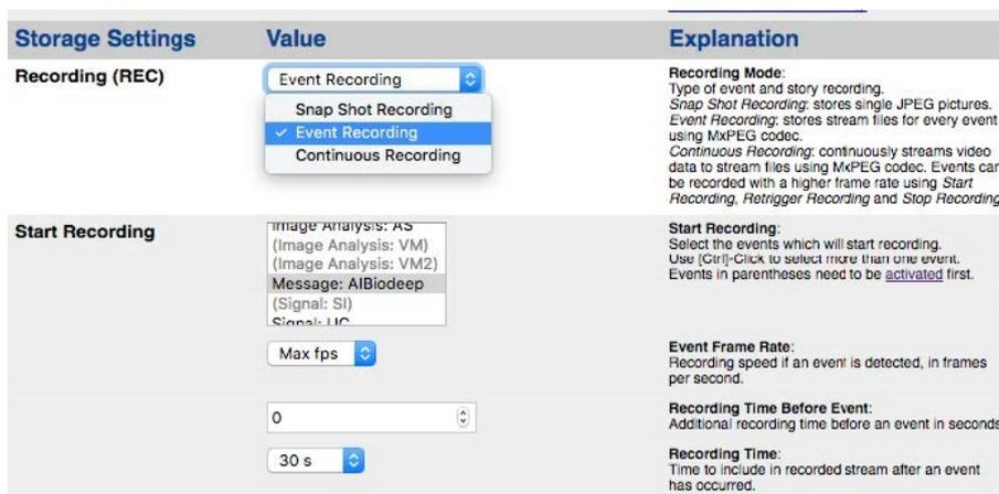
Abb. 31: Konfiguration der Aufnahmeeinstellungen der Kamera
