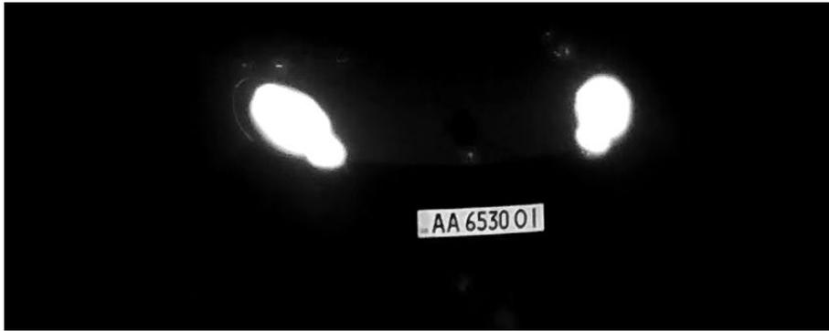
Abb. 11: Gut lesbares Kennzeichen bei Nacht mit Infrarot-LED-Beleuchtung
